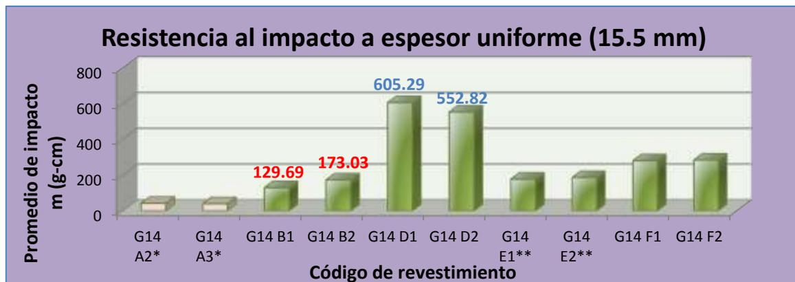
Figura 4.30: Resistencia al impacto según el espesor uniforme.
