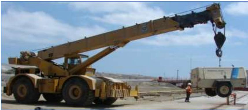
Figura 3.90: Maniobra para colocar el compresor en la lancha.
