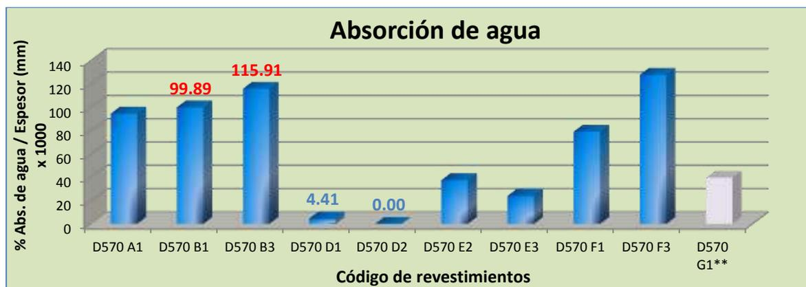
Figura 4.37: Porcentaje de agua absorbido según sistema evaluado.
