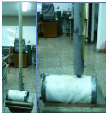
Figuras 4.27 y 4.28: Disposición de probetas en el ensayo de impacto.
