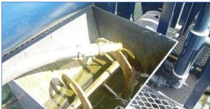
Figura 3.66: Lubricación de equipo APE.
