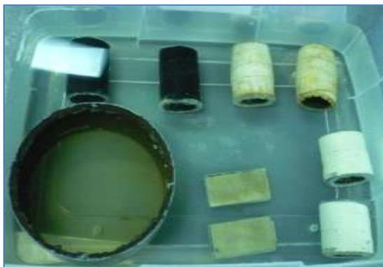
Figura 4.36: Disposición de probetas para la prueba de absorción de agua.
