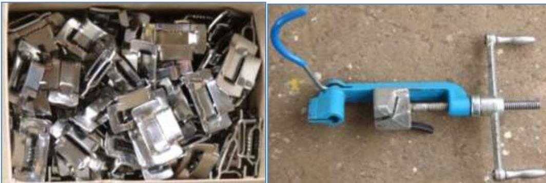
Figuras 1.8 y 1.9: Zunchos metálicos y herramienta de ajuste y corte.
