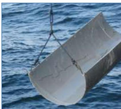
Figura 3.93: “Riserclad” cubierto con “Riserbond” listo para la aplicación.
