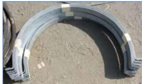
Figura 1.42: Abrazaderas de compresión.
