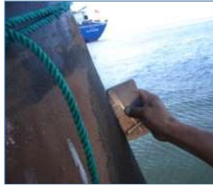
Figura 2.13: Medición de *pits*.
