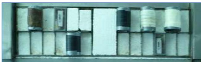
Figura 4.38: Disposición de probetas en la cámara de intemperismo.
