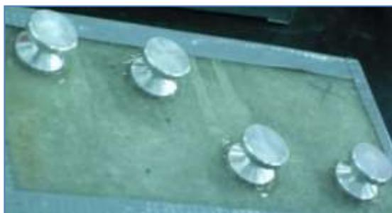
Figura 4.24: Distribución de *dollyes* sobre probeta del sistema E.
