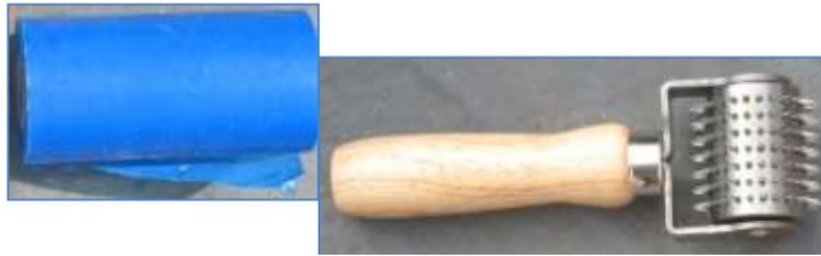
Figuras 1.14 y 1.15: Cinta de compresión y rodillo perforador.
