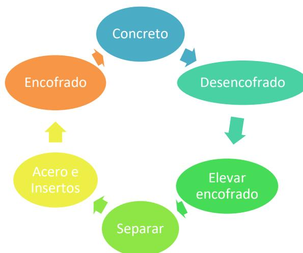
Figura N° 36. Esquema del proceso constructivo del Silo utilizando el encofrado trepante.
