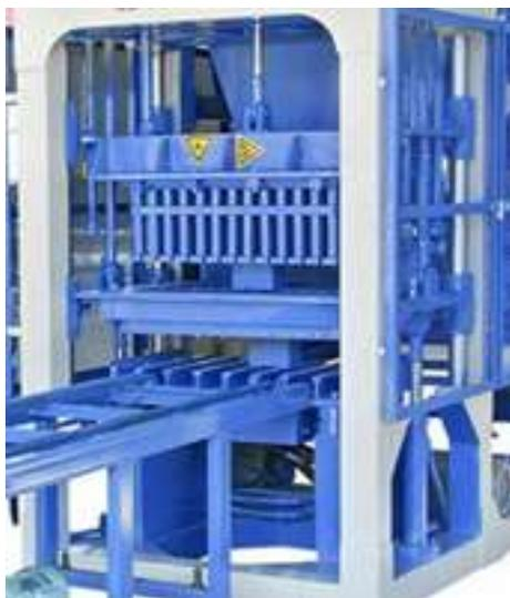
**Figura 5.** Máquina adoquinera compacta, semi automática e hidráulica
