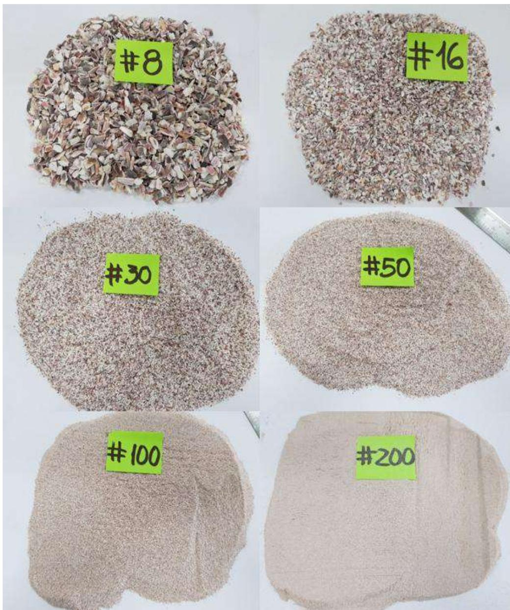
Figura 13. Partículas de valva de concha de abanico triturada, según los diferentes tamaños de tamiz recomendados por la ASTM C-144.
