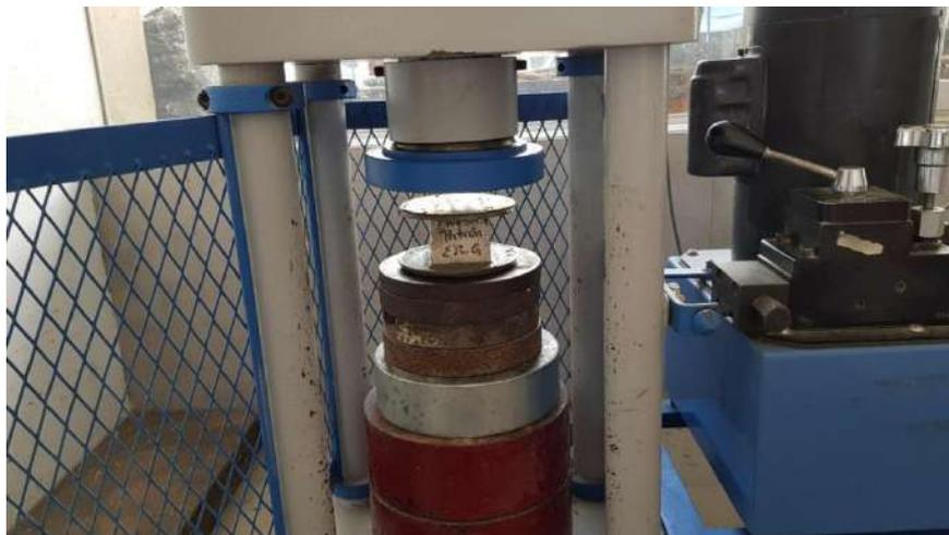
Figura 6. Ensayo de muestras cúbicas en máquina a compresión.
