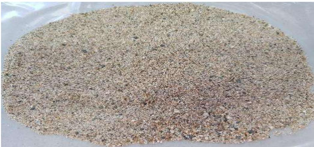
Figura 8. Agregado fino (arena de la cantera de Chulucanas).
