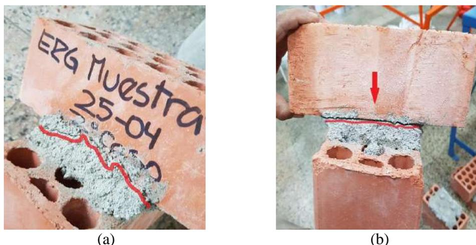
Figura 23. Fallas en los ensamblajes de ladrillos cruzados para la mezcla con  $a/c$  variable a) Línea roja indicando la falla b) Falla por rajadura de junta. No se presentó separación total de la unidad con el mortero.
