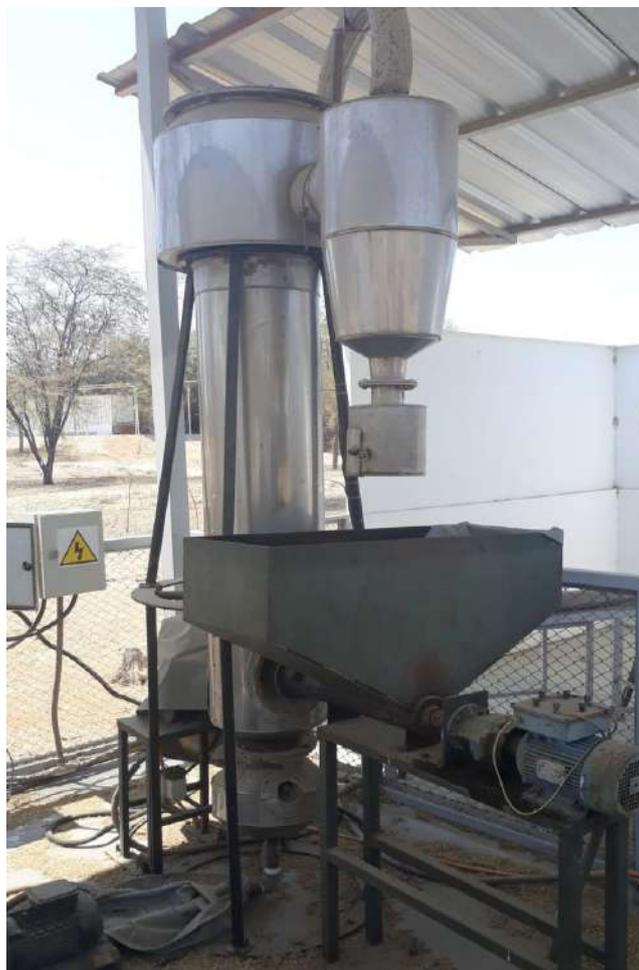
Figura 16. Gasificador UDEP de lecho fluidizado
