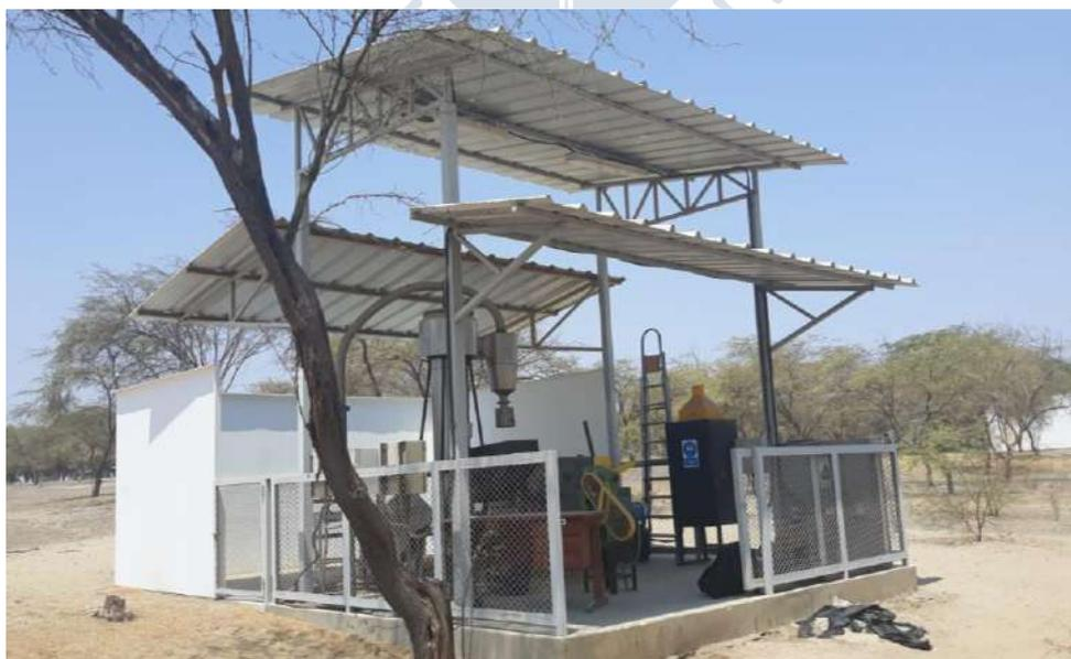
Figura 56. Planta piloto para gasificación de biomasa en la Universidad de Piura
