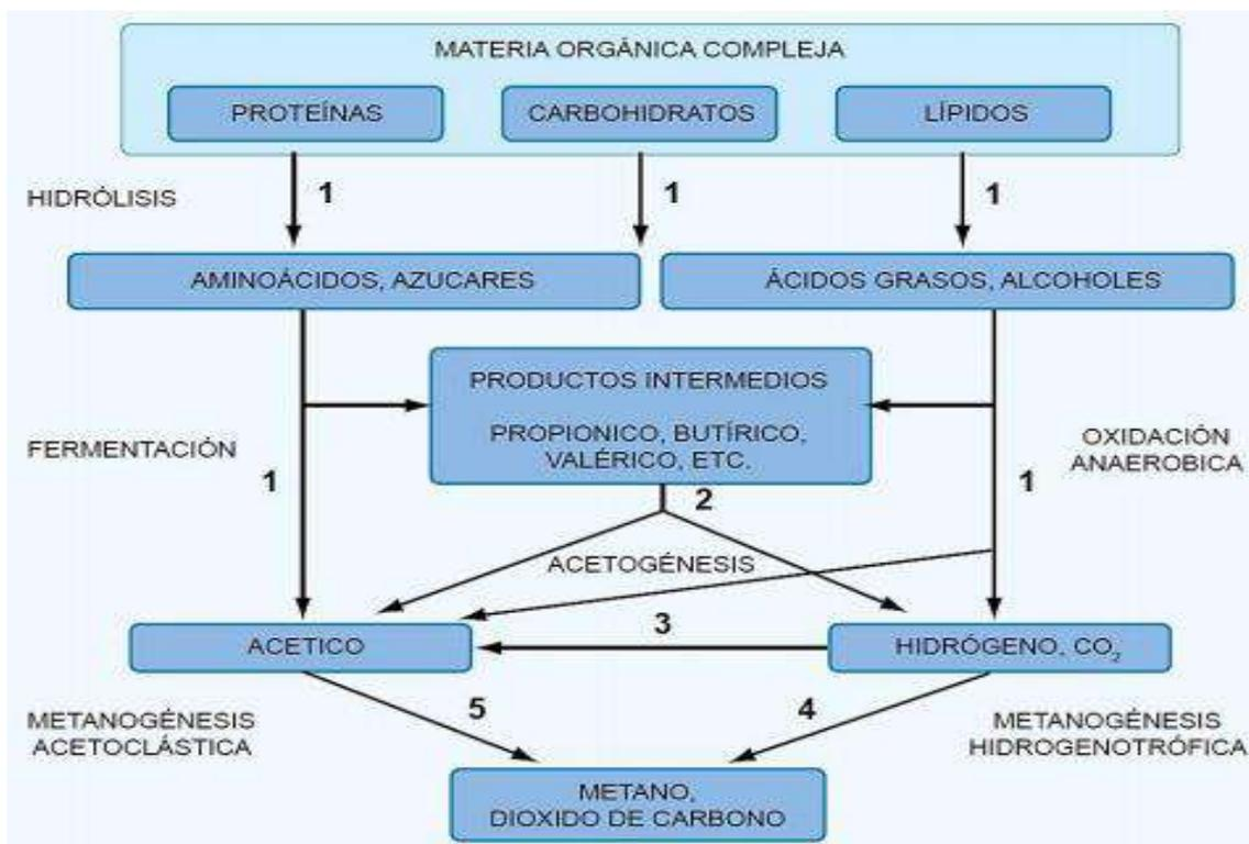
Figura 7. Esquema de las etapas del proceso de biodigestión de materia orgánica compleja
