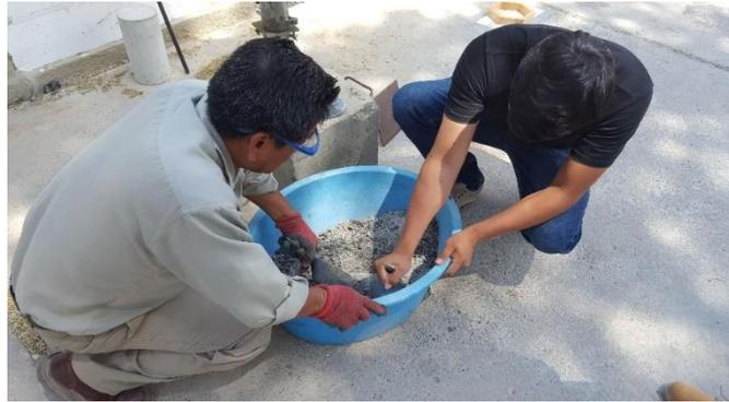
*Ilustración 36 - Elaboración de concreto para probetas cilíndricas y prototipo final*
