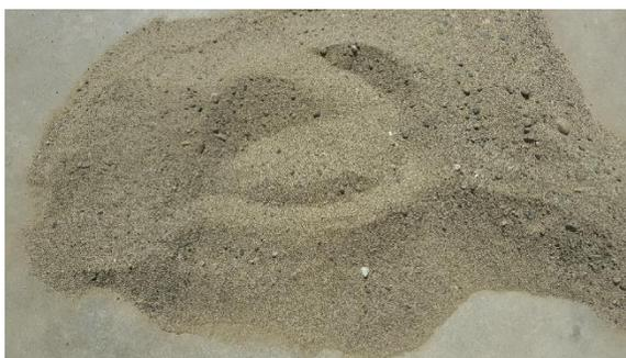
*Ilustración 33 - Agregado fino procedente de cantera Santa Cruz.
