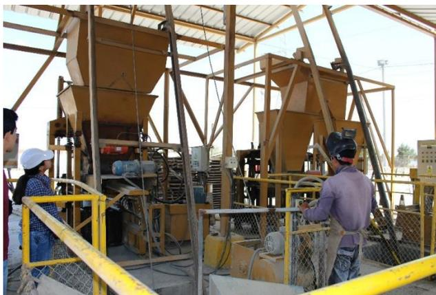
*Ilustración 43. Bloqueras de la planta InkaBlock
