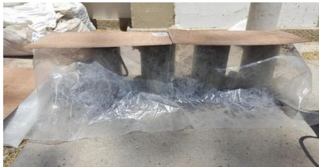
*Ilustración 37 - Probetas de concreto para ensayo de compresión.*
