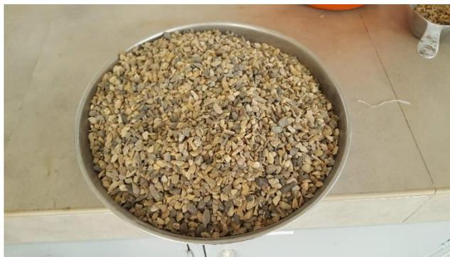
*Ilustración 32 - Agregado grueso procedente de cantera Santa Cruz.
