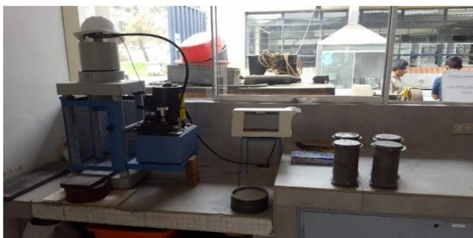
*Ilustración 39 - Probetas de concreto y máquina para ensayos de compresión.
