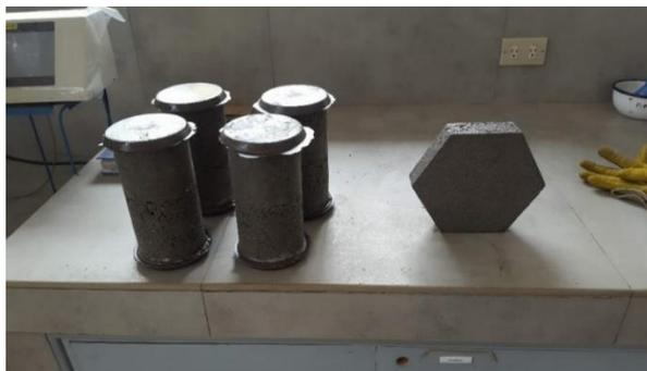
*Ilustración 38 - Probetas capeadas y prototipo final.
