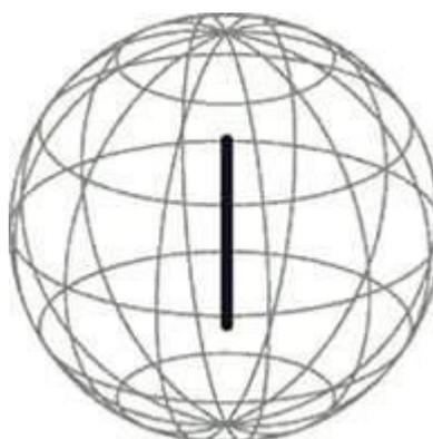
Figura 5. Esquema de un radiador isotrópico.
