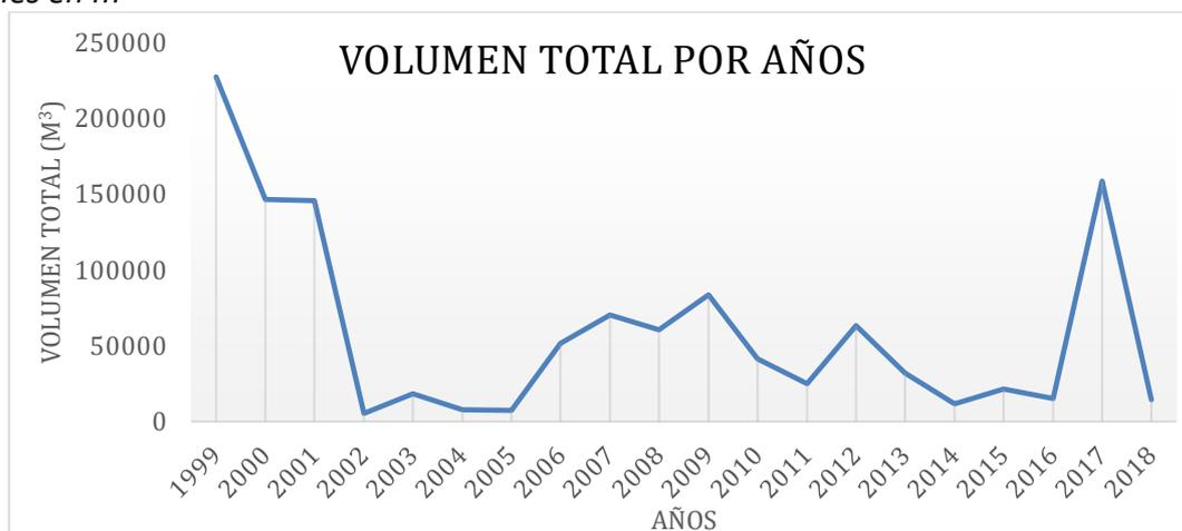
*Fuente* Tomado y adaptado de “Estudio sobre la colmatación del cauce del río Rímac en el tramo que pasa por la Base Naval del Callao en el periodo de 1999 a 2018”
