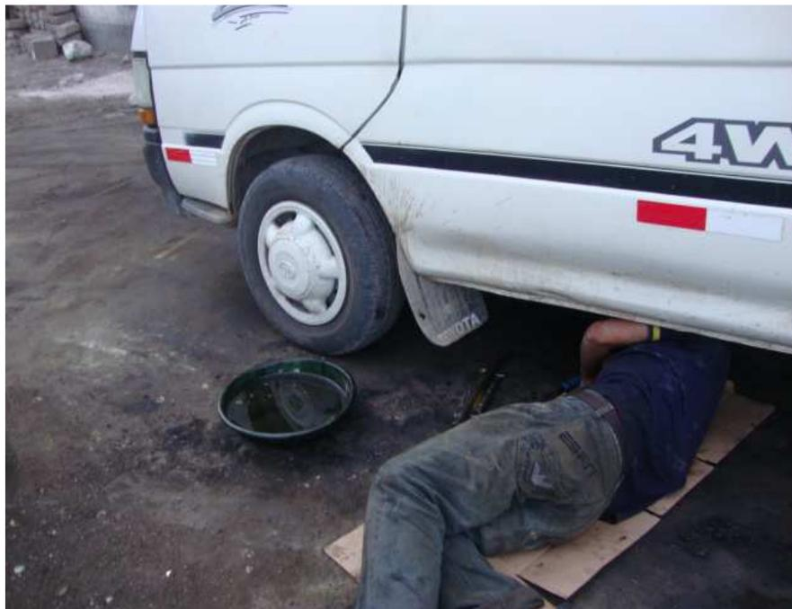
**Foto 6.** Trabajador de una empresa de servicio de cambio de aceite. Realizando labores en vía pública; obsérvese el derrame, Condiciones de recipientes de almacenamiento, indumentaria del personal. Ayacucho – 2010.
