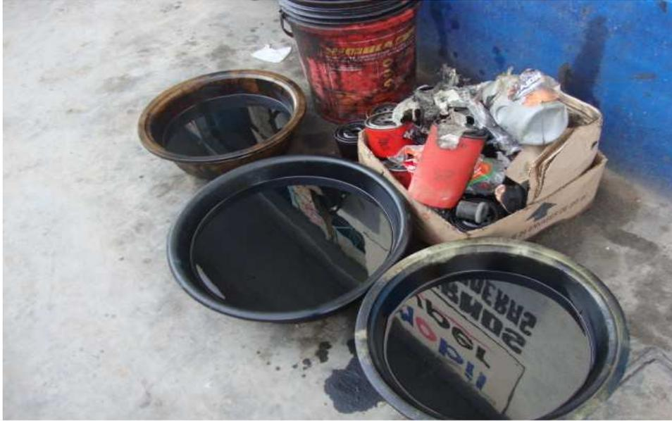
**Foto 1.** Condiciones inadecuadas de almacenamiento de aceite usado por parte del generador; obsérvese el derrame y disposición de filtros. Ayacucho – 2010.
