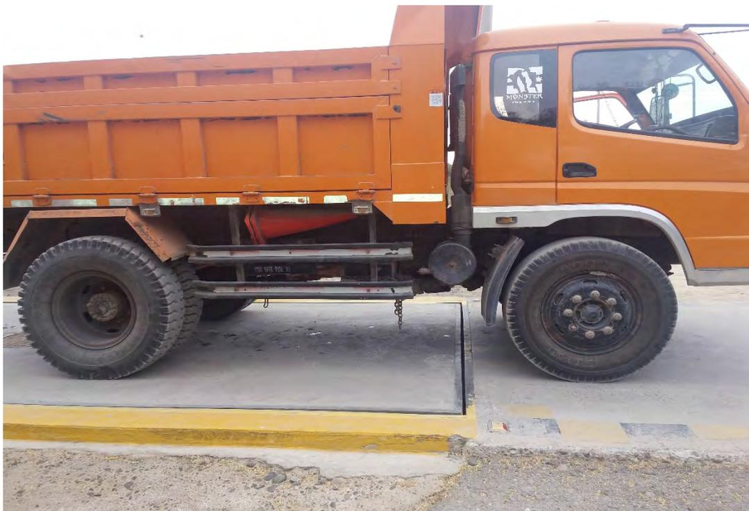
**Figura 37.** Pesaje del camión.
