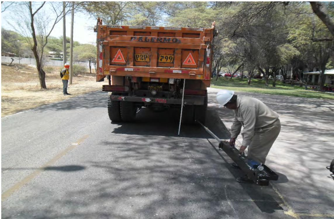
**Figura 44.** Colocación de la viga Benkelman en el punto a evaluar.
