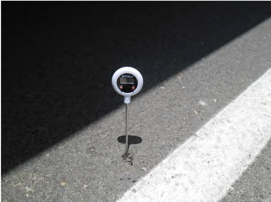
**Figura 46.** Medición de la temperatura del asfalto.
