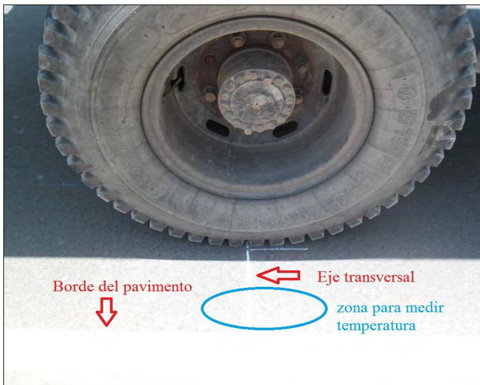
**Figura 25.** Medición de temperatura
