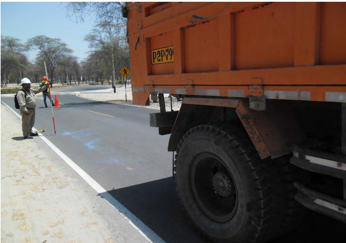
**Figura 42.** Ubicación del centro de gravedad de la llanta doble en el punto a evaluar.
