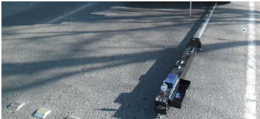
**Figura 37.** Viga Benkelman de la Universidad de Piura.
