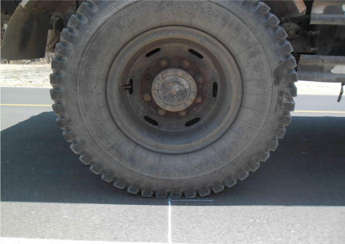
**Figura 43.** Correcta ubicación en el centro de gravedad de la llanta doble.
