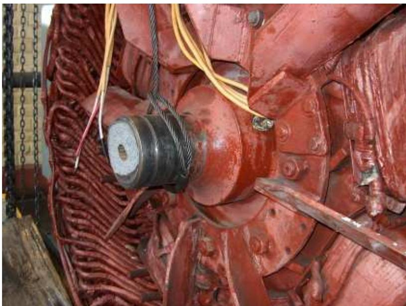
**Figura N° 5.1.- Vista del eje en su sección de falla.**
