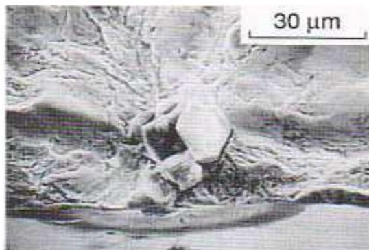
Figura N°1.10.- Orígenes de fisuración por fatiga en un acero.
