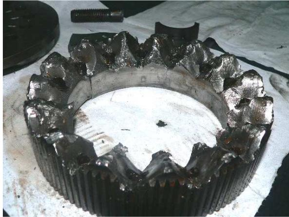
**Figura N°1.5.-** Caso de falla por fatiga debido a torsión de un spindle. El patrón es a través de planos de 45°.
