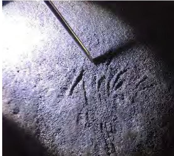
**Figura 95.** Sección de cocina mejorada mostrando una irregularidad en la superficie.
