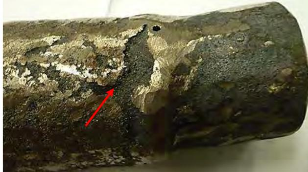
**Figura 57.** Se muestra una cavidad esférica en la superficie.
