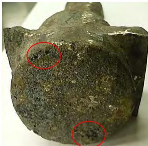
**Figura 56.** Superficie de la mazarota. Se muestran cavidades de forma irregular.
