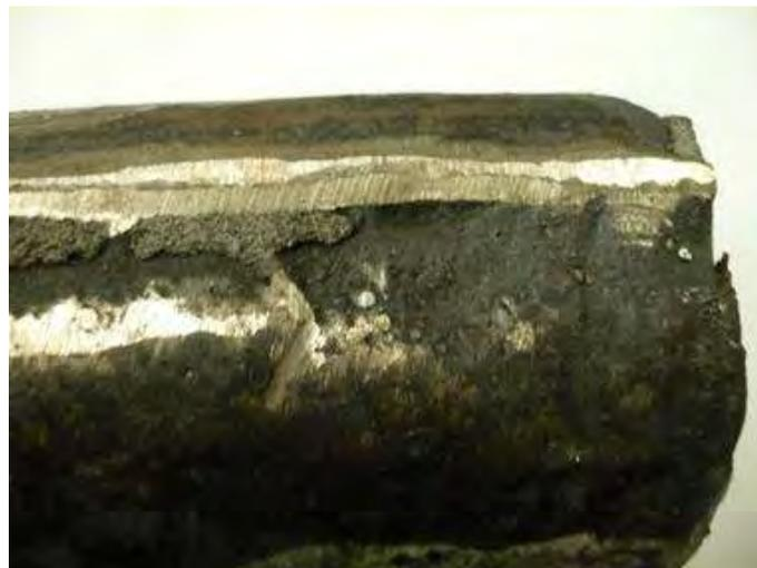
**Figura 60.** Barra de hierro gris en estado de colada. Se observa una superficie irregular de aspecto granular.
