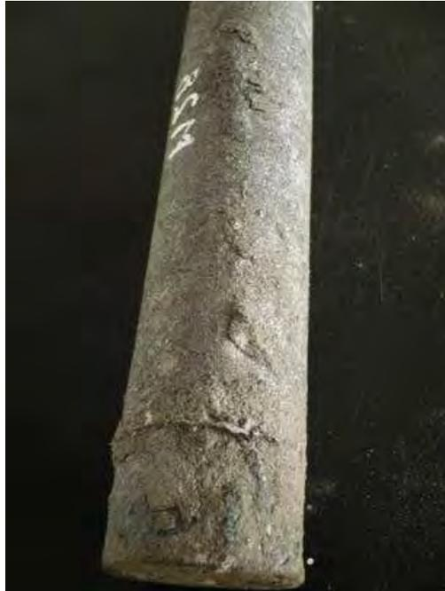
**Figura 49.** Cavidades sobre la superficie de la barra rellenas.
