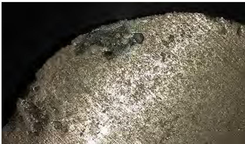
**Figura 64.** Sección transversal de la barra de hierro gris. Se muestra cavidades de forma irregular.
