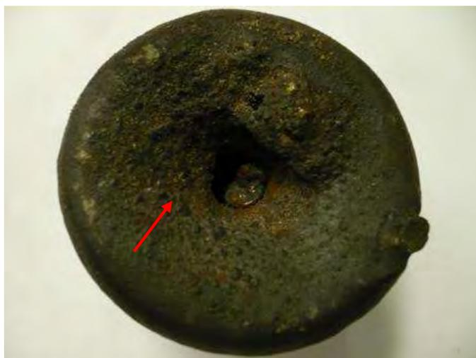
**Figura 52.**Extremo de la barra de hierro gris. Se señala la profundidad del rechupe primario en uno de los extremos de la barra.
