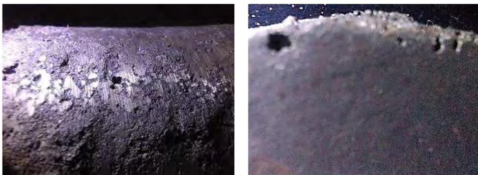
**Figura 66.** Acercamiento de una sección de la pieza. a) Se muestran cavidades. b) Corte transversal de la barra, se observan picaduras en superficie.
