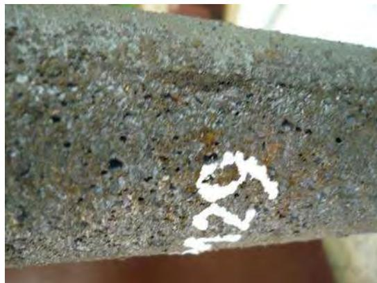
**Figura 100.** Acercamiento de una sección de la pieza, se muestran cavidades.
