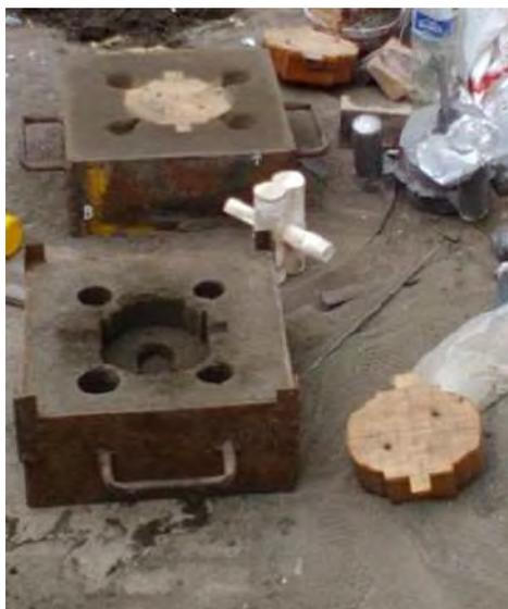
**Figura 36.** Extracción del modelo de la semicaja de moldeo.
