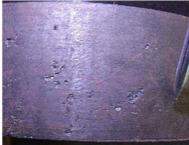
**Figura 77.**Superficie de la barra de hierro gris. Se muestra cavidades de forma irregular.
