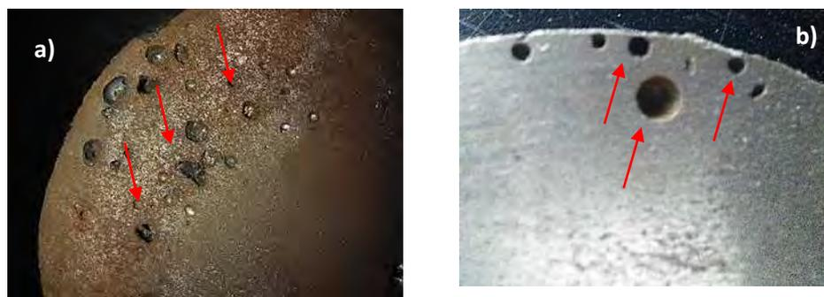
**Figura 44.** Corte transversal de la barra. a) Cavidades esféricas a una distancia de la superficie de la barra. b) Cavidades esféricas sub-superficiales.
