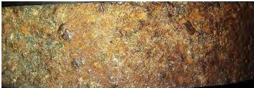
**Figura 63.** Barra de hierro gris en estado de colada. Acercamiento de la superficie, se observa una superficie irregular con aspecto granular.
