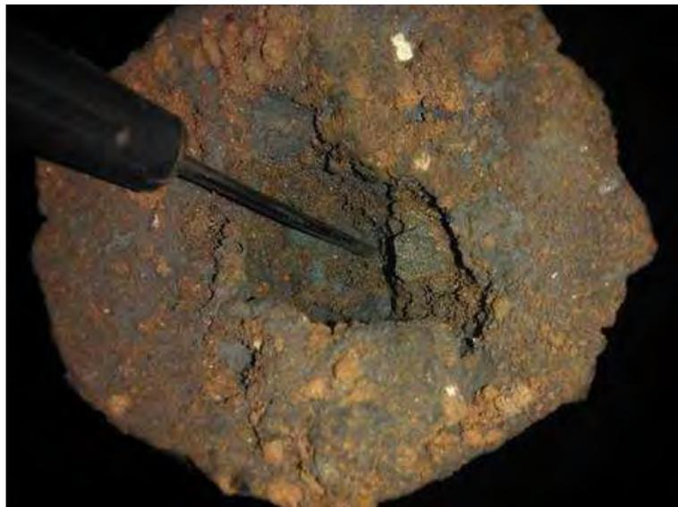
**Figura 67.** Extremo de la pieza. Se señala la profundidad del rechupe primario.
