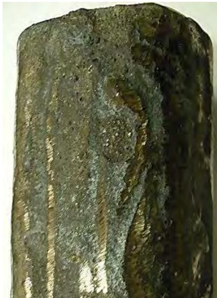
**Figura 58.** Barra de hierro gris en estado de colada. Se observa una superficie irregular de aspecto granular.
