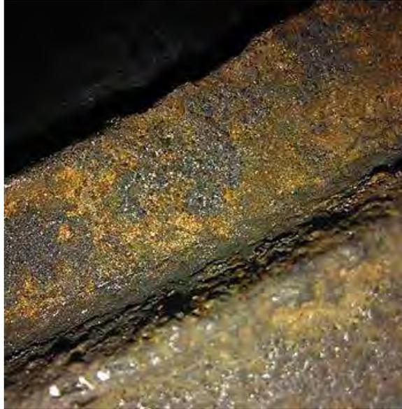
**Figura 97.** Trozo de cocina mejorada en estado de colada. Acercamiento de la superficie, se muestra una superficie irregular de aspecto granular.
