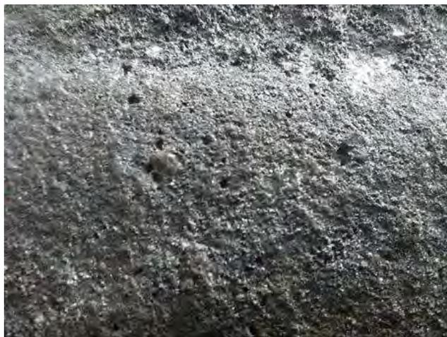
**Figura 96.** Acercamiento de una sección de la pieza, se muestran cavidades.
