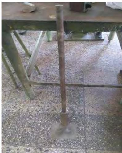
**Figura D.5.** Marinete fabricado en el Laboratorio de Suelos. Marinete simple (sin contrapeso para elaboración de probetas).
