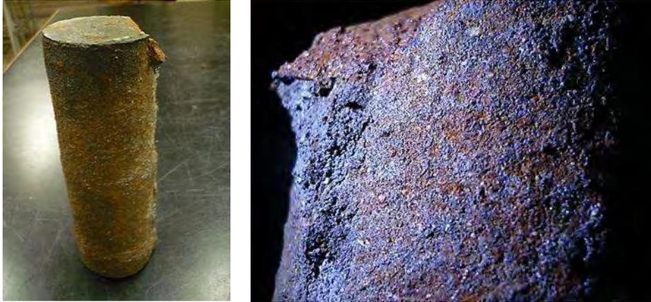
**Figura 81.** Barra de hierro gris en estado de colada. a) Vista panorámica de la barra. b) Acercamiento de la superficie, se observa una superficie irregular con aspecto granular.
