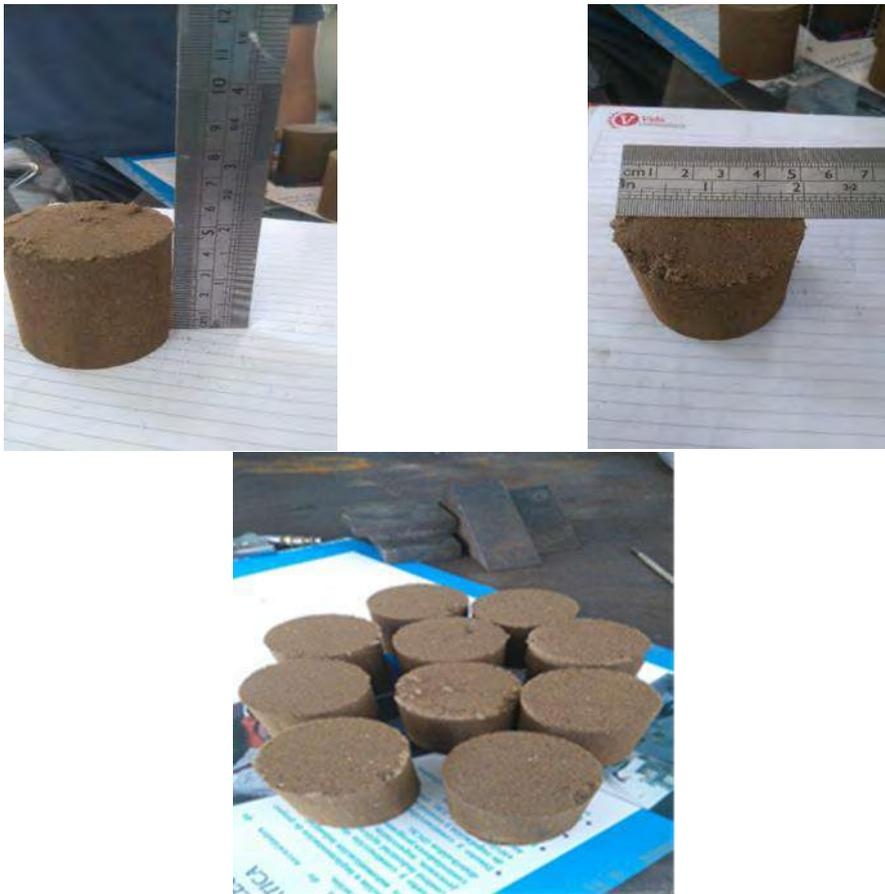
**Figura D.8.** Probeta estandarizada según la norma AFS.
