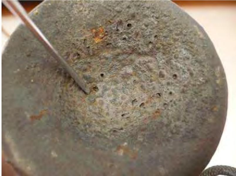
**Figura 85.** Extremo de la barra de hierro gris. Se señala la profundidad del rechupe primario (15 mm).
