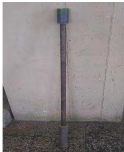
**Figura D.6.** Marinete con el contrapeso adicional en la parte superior.
