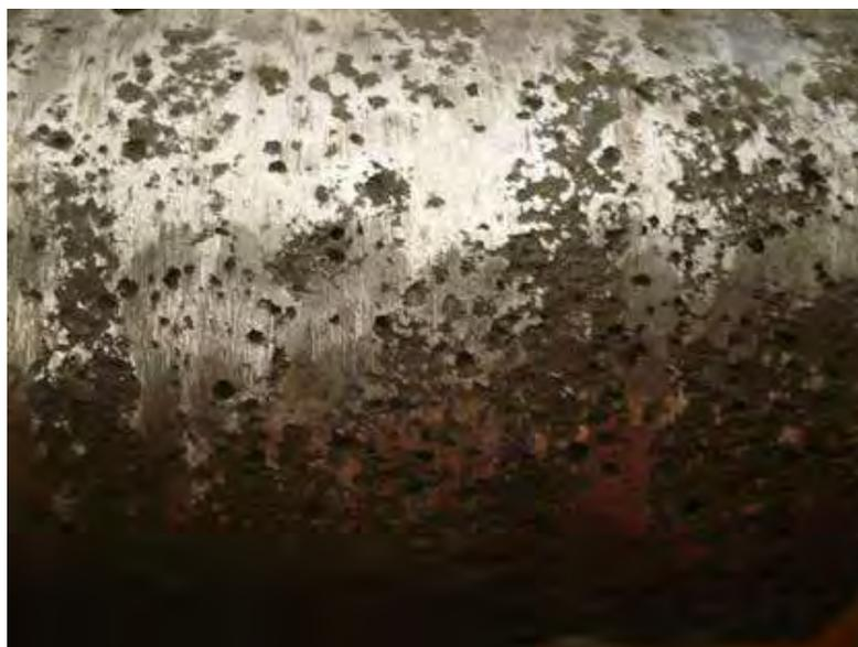
**Figura 84.**Picaduras superficiales en sección lateral de la barra de hierro colado.
