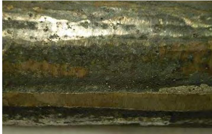
**Figura 61.** Barra de hierro gris en estado de colada. Se observa una superficie irregular de aspecto granular.
