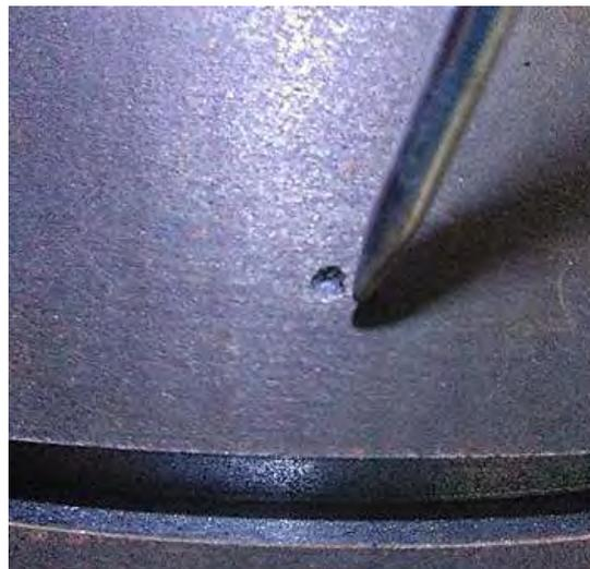
**Figura 76.**Pieza de Fundición Rivera, que muestra una cavidad.
