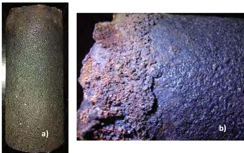
**Figura 68.** Barra de hierro gris en estado de colada. a) Vista panorámica de la barra. b) Acercamiento de la superficie, se observa una superficie irregular con aspecto granular.
