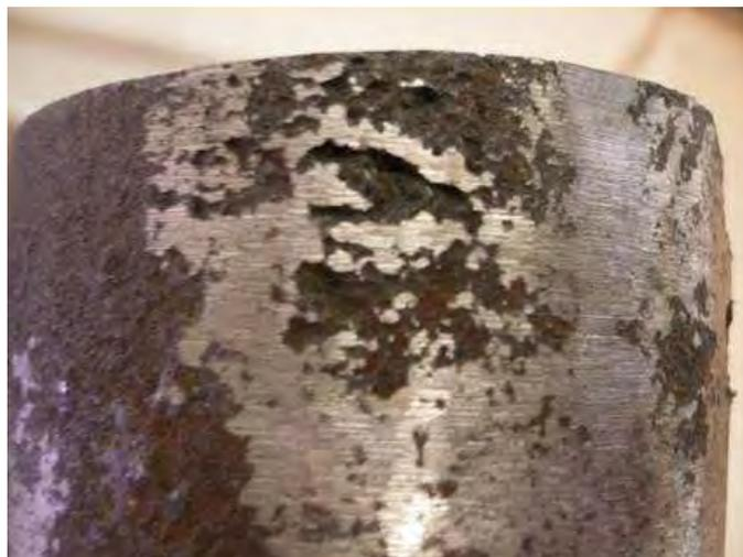
**Figura 86.** Superficie de la barra de hierro gris. Se muestra cavidades de forma irregular.
