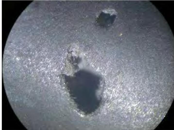
**Figura 53.** Sección transversal de la barra de hierro gris. Se muestra cavidades de forma irregular.
