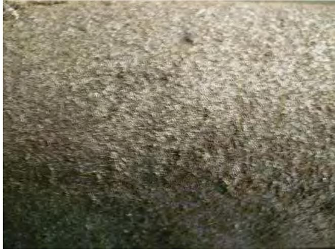
**Figura 45.**Superficie exterior de la barra irregular.
