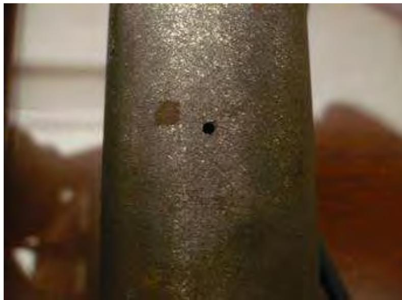
**Figura 74.** Barra mecanizada. Se muestra una cavidad esférica en la superficie.
