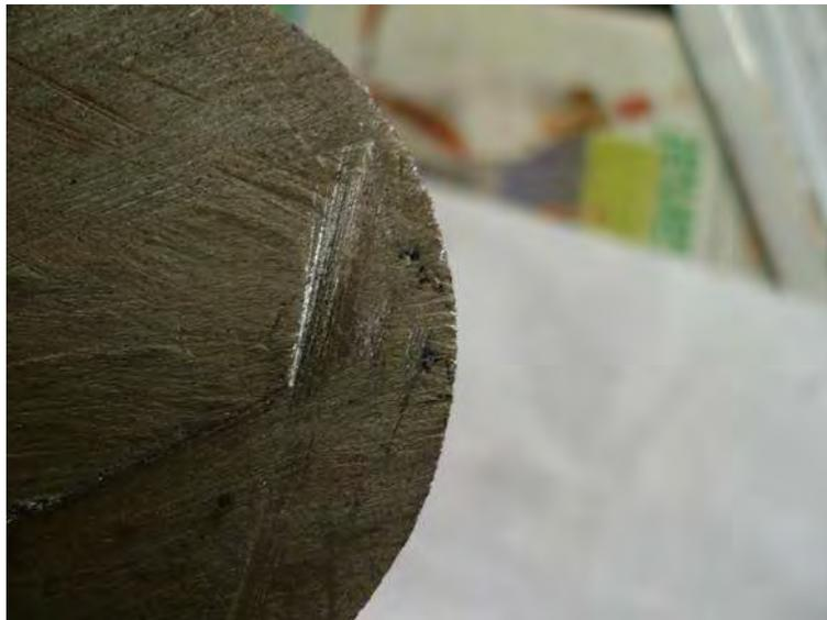
**Figura 79.** Cavidades irregulares conectadas a la superficie exterior de la pieza.
