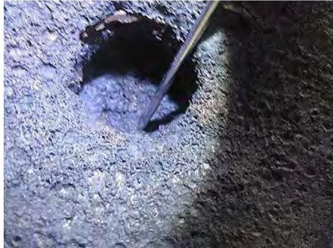
**Figura 75.**Extremo de la pieza. Se señala la profundidad del rechupe primario en uno de los extremos.
