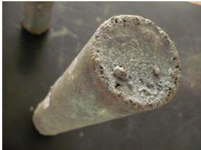
**Figura 50.** Cavidades huecas en el extremo superior de la barra.
