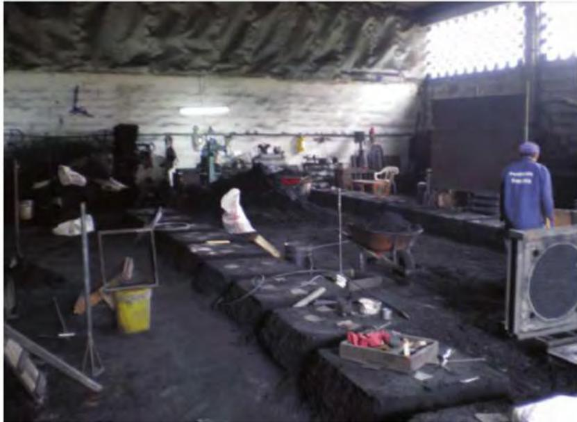
**Figura 20.** Área de moldeo en una fundición.
