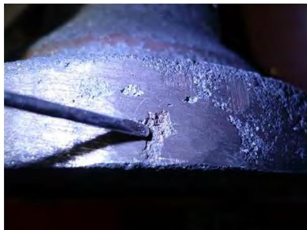
**Figura 92.** Borde inferior de la pieza "manguito". Se muestra cavidades de forma irregular.
