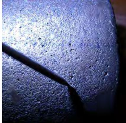
**Figura 93.** Picaduras en toda la superficie de la pieza de hierro colado.
