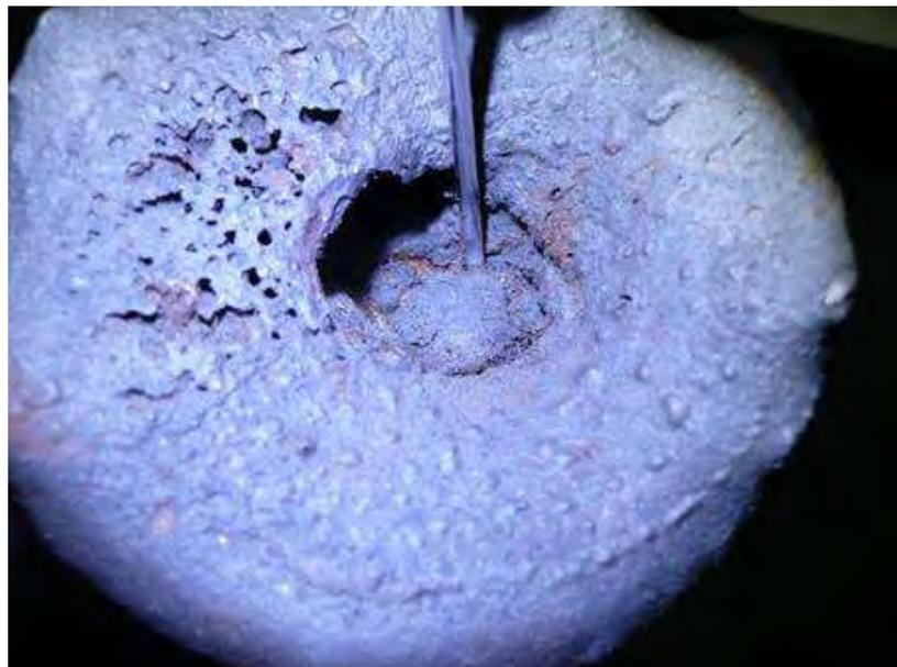
**Figura 82.** Extremo de la barra de hierro gris. Se señala la profundidad del rechupe primario en uno de los extremos de la barra.
