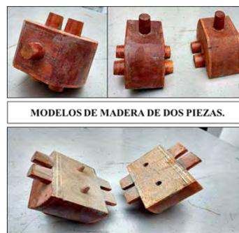
**Figura 31.** Modelos de madera compuestos por dos piezas.
