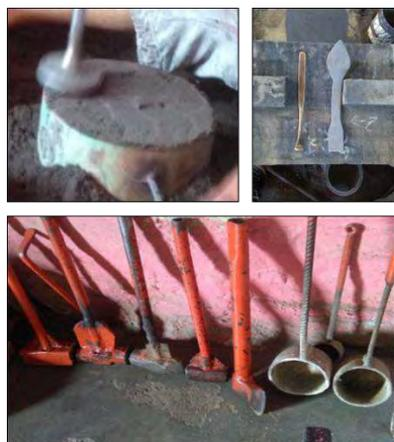
**Figura 34.**Herramientas para compactación del molde.
