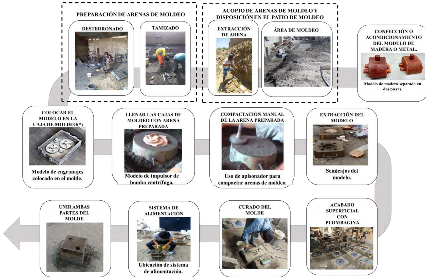
**Figura 29.** Esquema del proceso de moldeo del norte del Perú.
