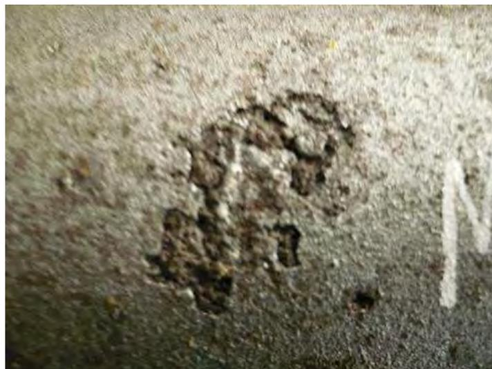
**Figura 46.**Cavidades irregulares rellanadas en la superficie externa de la barra.
