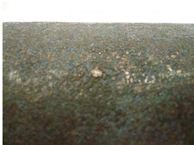
**Figura 78.**Superficie irregular de la barra, proporcionada por el taller 6.
