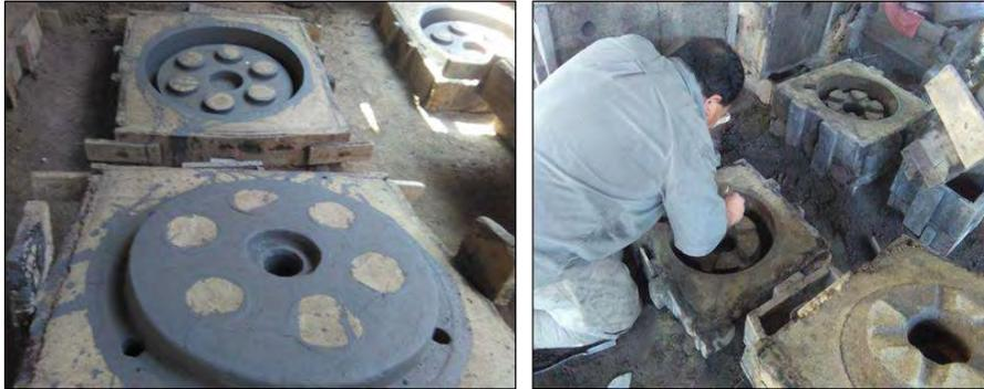
**Figura 37.** Revestimiento de los moldes con plombagina.
