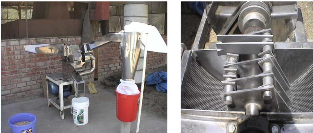
Figura 4.3. Molino de martillos monofásico de 7.5 HP
