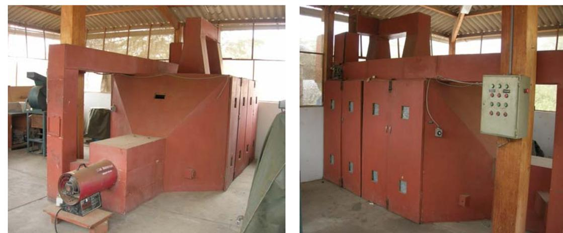
Figura 4.3. Secador a gas de la planta piloto de la UDEP
