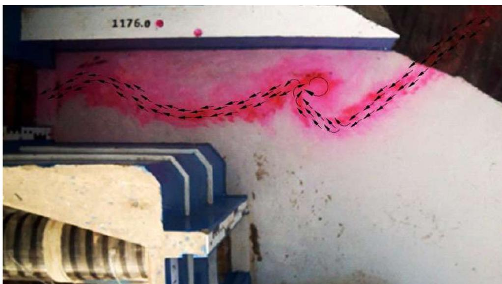
Figura 28. Líneas de corriente hacia el túnel 1 –  $Q = 300 \text{ m}^3/\text{s}$
