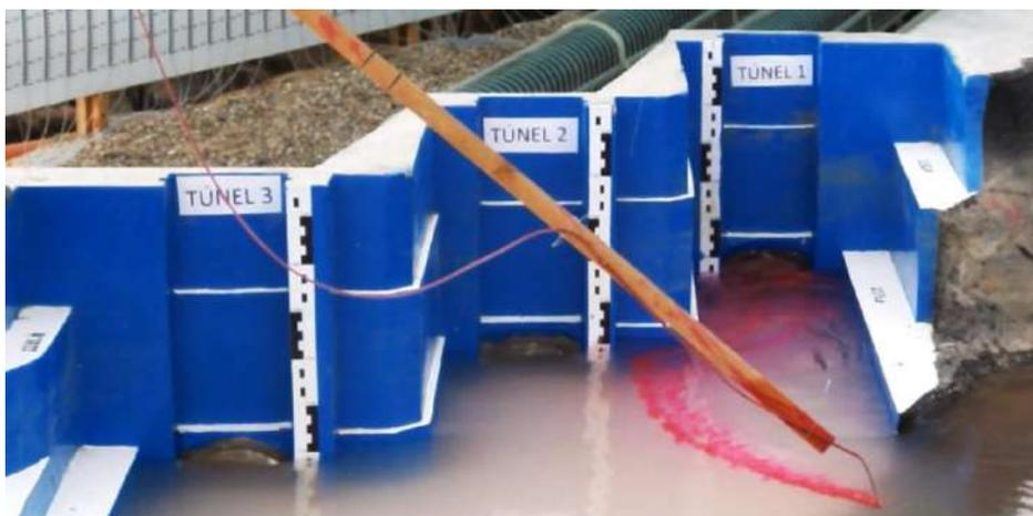
Figura 32. Líneas de corriente hacia el túnel 1 –  $Q = 2845 \text{ m}^3/\text{s}$
