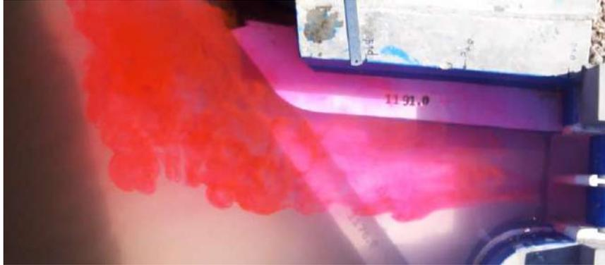
Figura 50. Líneas de corriente desde la margen izquierda hacia la bocatoma –  $Q = 30.9 \text{ m}^3/\text{s}$
