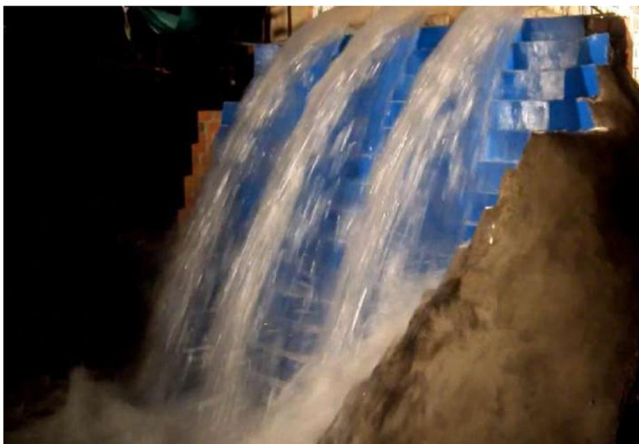
Figura 43. Características del chorro –  $Q = 5630 \text{ m}^3/\text{s}$
