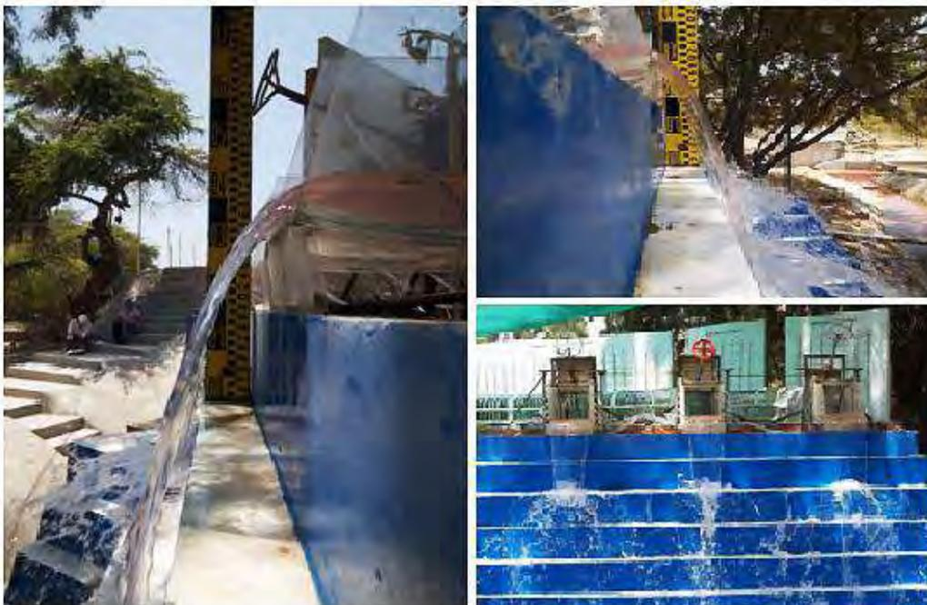
Figura 24. Características del chorro: vista de perfil y frontal –  $Q = 120 \text{ m}^3/\text{s}$
