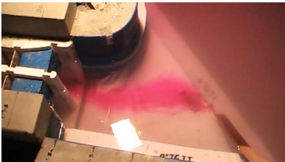
Figura 52. Líneas de corriente desde la margen derecha hacia la bocatoma –  $Q = 154.2 \text{ m}^3/\text{s}$
