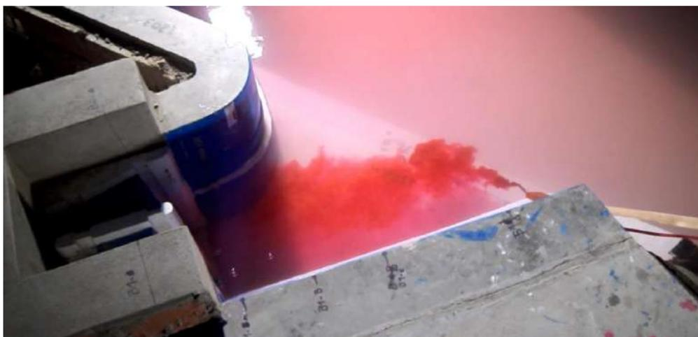
Figura 53. Líneas de corriente desde la margen izquierda hacia la bocatoma –  $Q = 154.2 \text{ m}^3/\text{s}$
