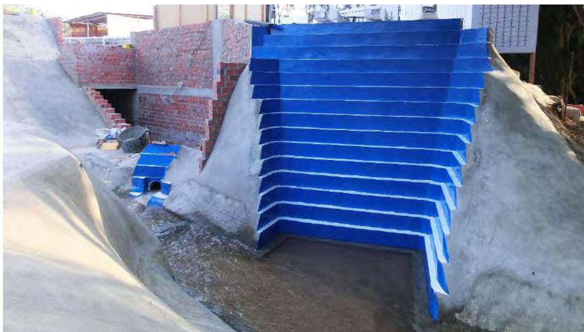
Figura 106. Configuración inicial del cuenco amortiguador
