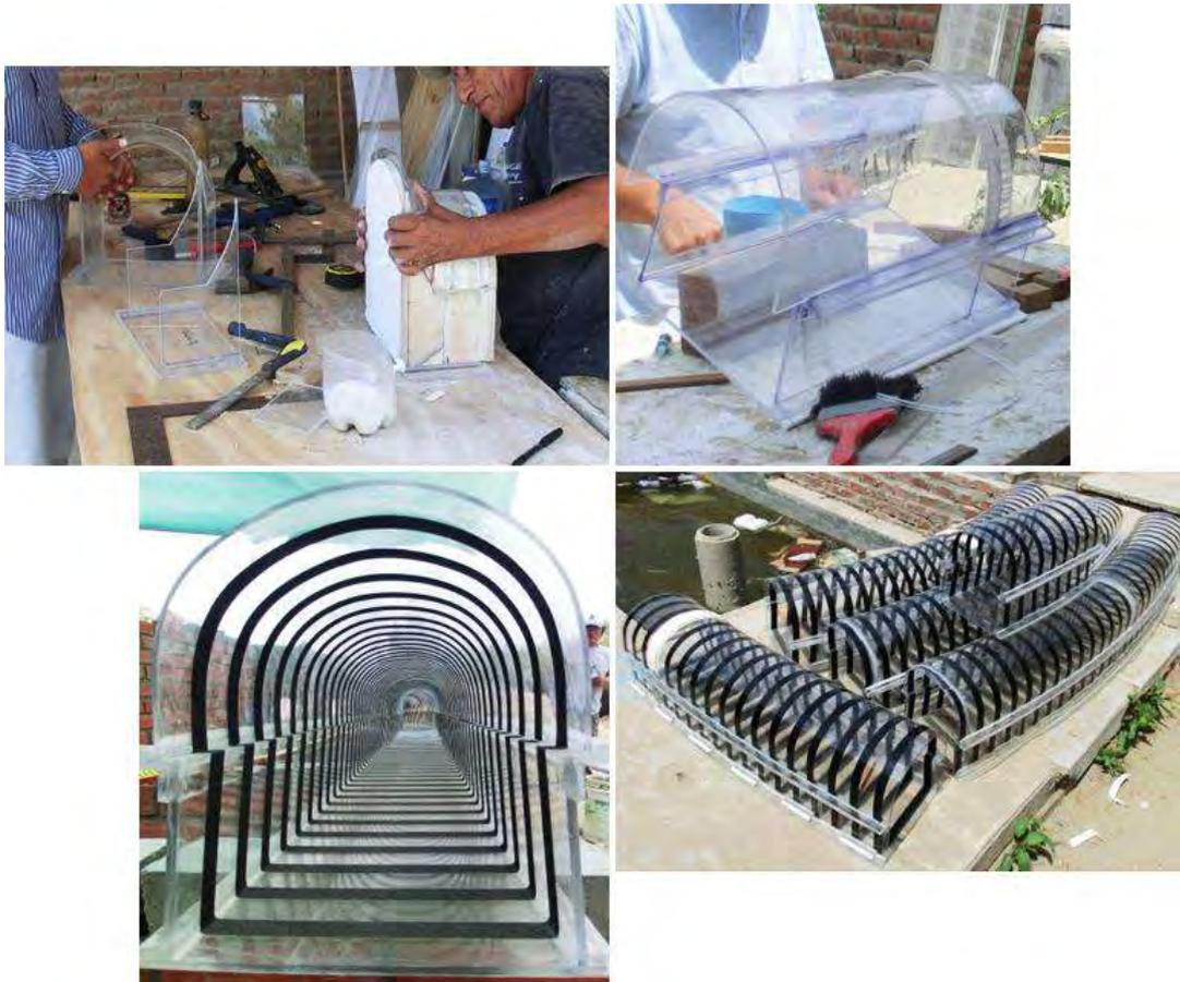
Figura 99. Elaboración de los túneles de vertedero, según las especificaciones
