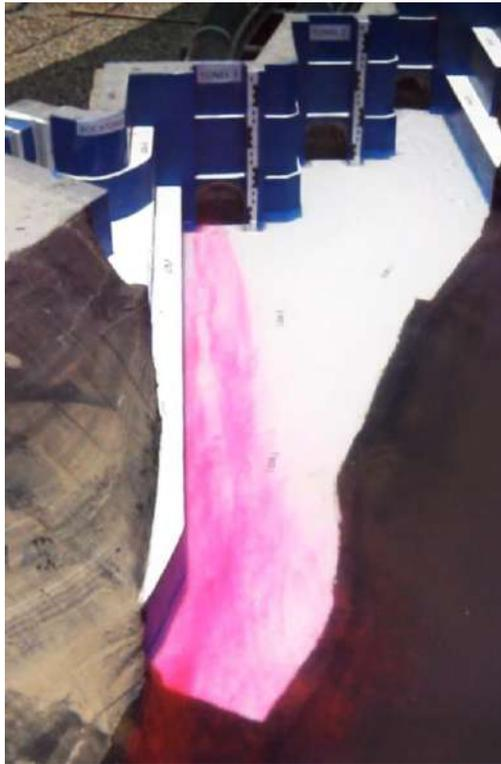
Figura 111. Líneas de corriente hacia el túnel 3 –  $Q = 641 \text{ m}^3/\text{s}$
