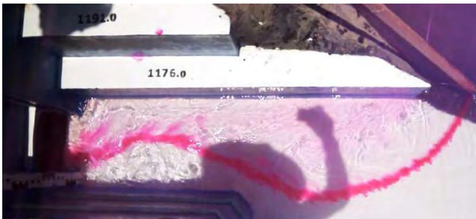
Figura 109. Líneas de corriente hacia el túnel 1 –  $Q = 641 \text{ m}^3/\text{s}$
