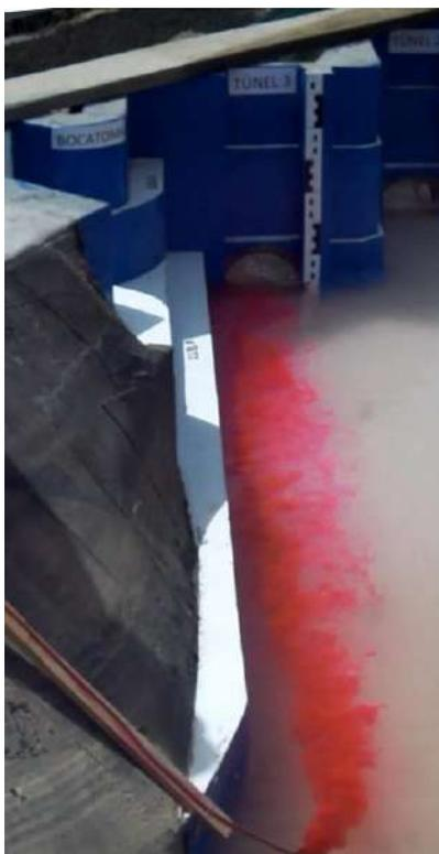
Figura 114. Líneas de corriente hacia el túnel 3 –  $Q = 1832 \text{ m}^3/\text{s}$
