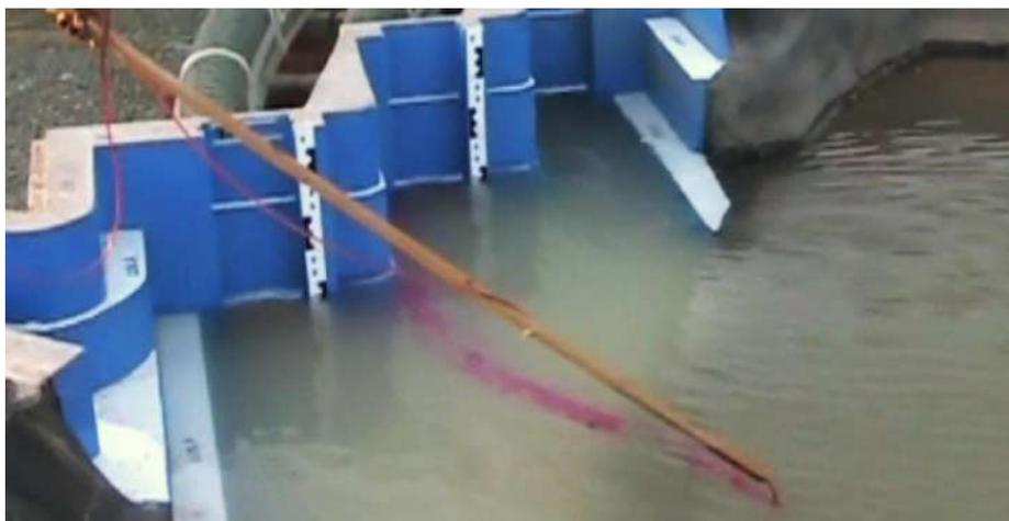
Figura 116. Líneas de corriente hacia el túnel 2 –  $Q = 3621 \text{ m}^3/\text{s}$
