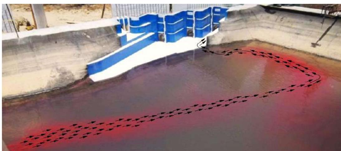
Figura 23. Líneas de corriente desde la margen izquierda del embalse –  $Q = 120 \text{ m}^3/\text{s}$
