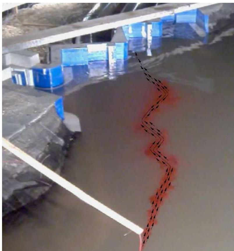
Figura 41. Líneas de corriente hacia el túnel 2 –  $Q = 5630 \text{ m}^3/\text{s}$
