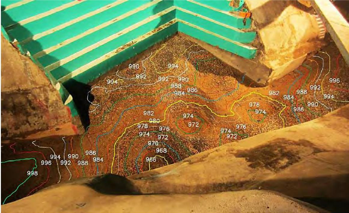
Figura 77. Curvas de nivel de la poza disipadora erosionada –  $Q = 1832 \text{ m}^3/\text{s}$
