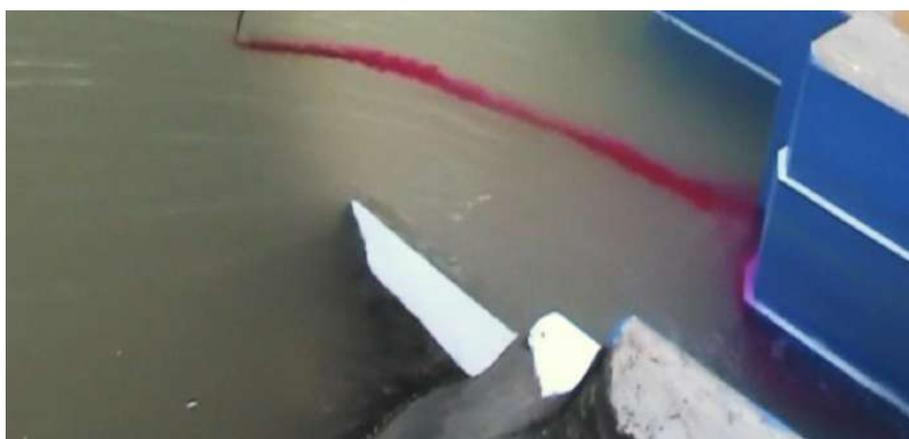
Figura 115. Líneas de corriente hacia el túnel 1 –  $Q = 3621 \text{ m}^3/\text{s}$
