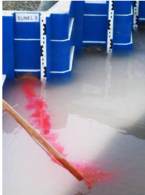
Figura 34. Líneas de corriente hacia el túnel 3 –  $Q = 2845 \text{ m}^3/\text{s}$
