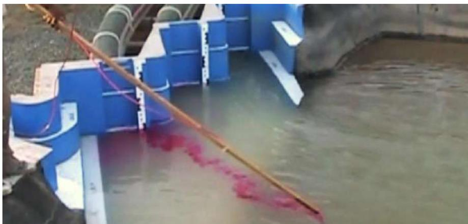
Figura 117. Líneas de corriente hacia el túnel 3 –  $Q = 3621 \text{ m}^3/\text{s}$
