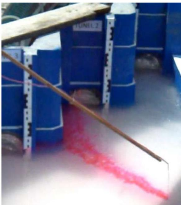
Figura 113. Líneas de corriente hacia el túnel 2 –  $Q = 1832 \text{ m}^3/\text{s}$
