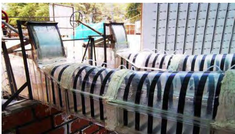
Figura 103. Instalación de compuertas ataguía
