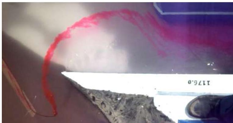
Figura 112. Líneas de corriente hacia el túnel 1 –  $Q = 1832 \text{ m}^3/\text{s}$
