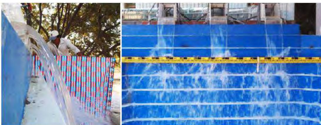
Figura 30. Características del chorro: vista de perfil y frontal –  $Q = 300 \text{ m}^3/\text{s}$
