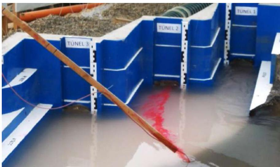
Figura 33. Líneas de corriente hacia el túnel 2 –  $Q = 2845 \text{ m}^3/\text{s}$
