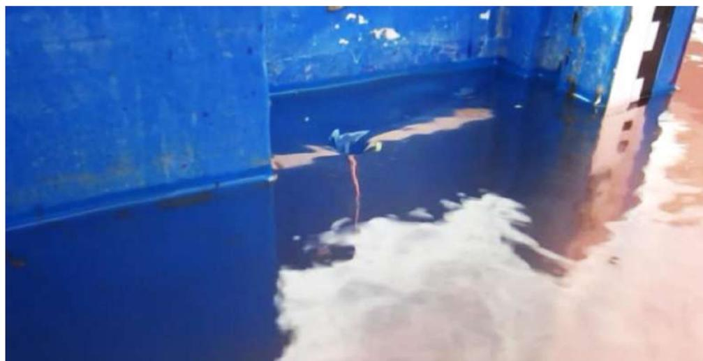
Figura 56. Formación de vórtice clase I a la entrada del túnel 3 – Abertura 10 m – 1196 m.s.n.m.
