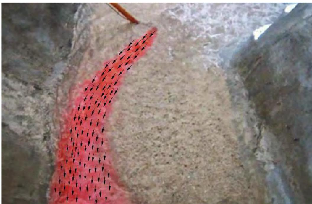
Figura 29. Líneas de corriente aguas abajo de la presa –  $Q = 300 \text{ m}^3/\text{s}$
