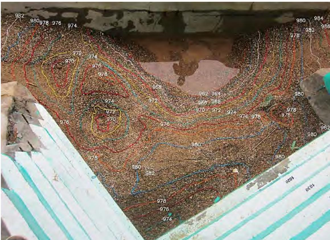
Figura 81. Curvas de nivel de la poza disipadora erosionada –  $Q = 2845 \text{ m}^3/\text{s}$
