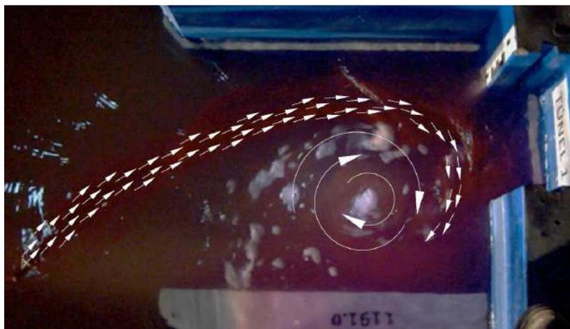
Figura 40. Vórtice de eje vertical en la entrada del túnel 1 –  $Q = 5630 \text{ m}^3/\text{s}$
