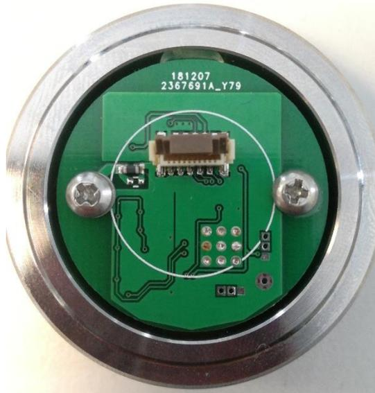
Figura 84. Circuito impreso de medición colocado en la celda de carga.
