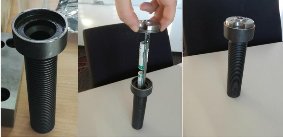
Figura 3. Montaje del clamp assist dentro del spindle.
