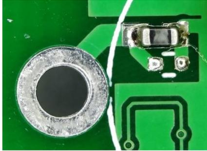
Figura 60. Conexión de la tierra del circuito impreso con la celda de carga.
