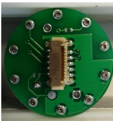
Figura 88. Vista posterior del circuito impreso necesario para conexión.
