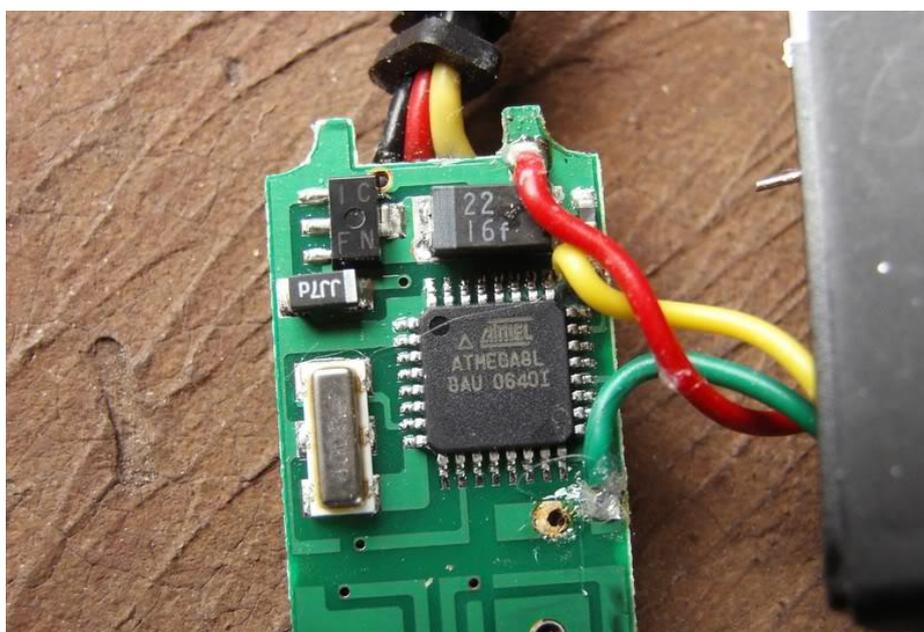
Figura 40. Sistema de control embebido: ATmega8L
