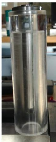
Figura 10. Prueba de perpendicularidad.
