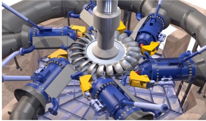
Figura 6. Turbina Pelton.
