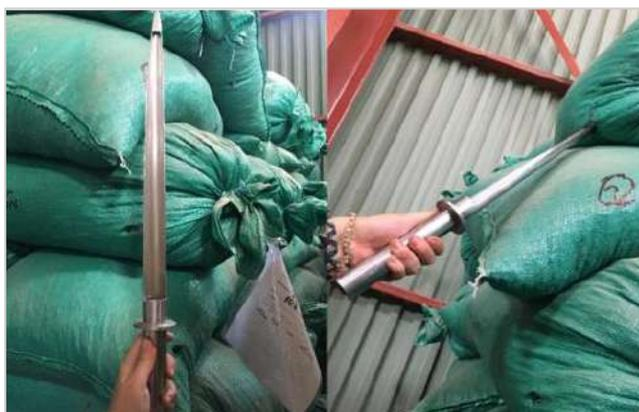
Figura 13. Pluma para extracción de muestras en almacén.
