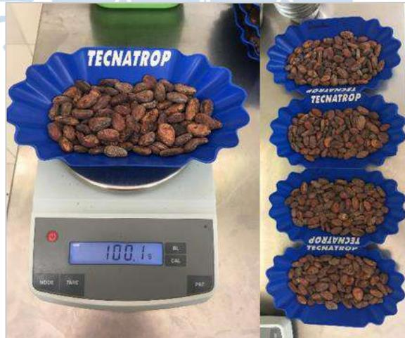
Figura 19. Separación de muestras en bandejas de 100g.
