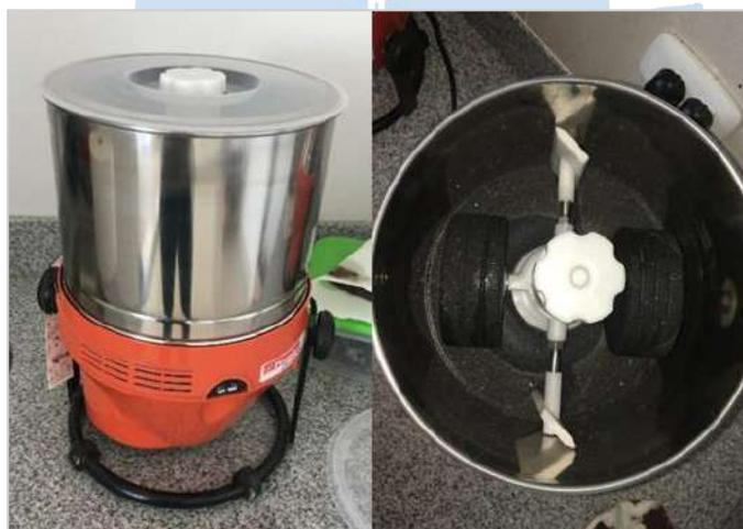
Figura 26. Máquina utilizada para el conchado de muestras.
