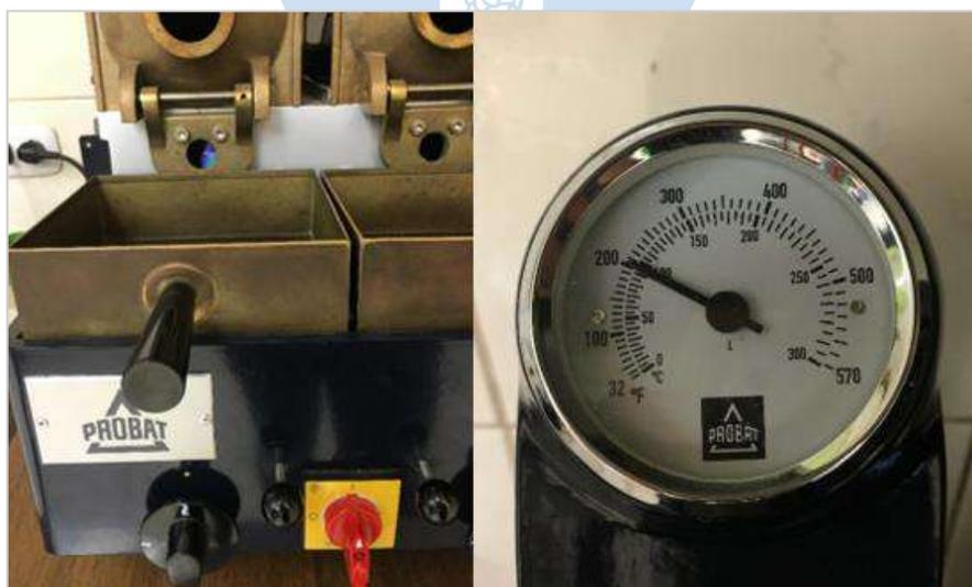
Figura 20. Mecanismos de control de temperatura durante el tostado.
