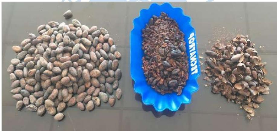
Figura 24. Separación de grano y cáscara en el descascarillado.
