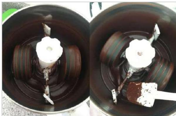
Figura 27. Máquina conchadora en funcionamiento.
