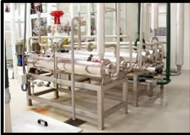
**Figura 4.7** Pasteurizador de superficie raspada
