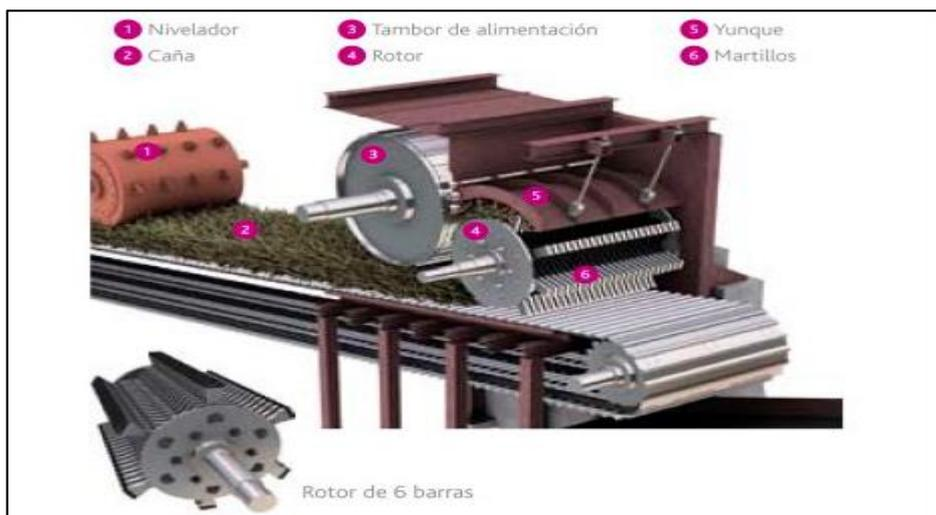
Figura 2.6 Partes de una desfibradora pesada.
