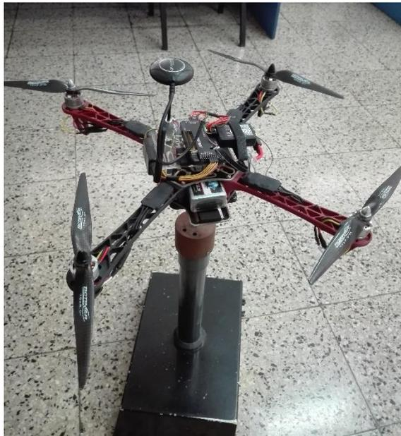
Figura 4.31. Cuadricóptero implementado en el banco de pruebas del laboratorio SAC.
