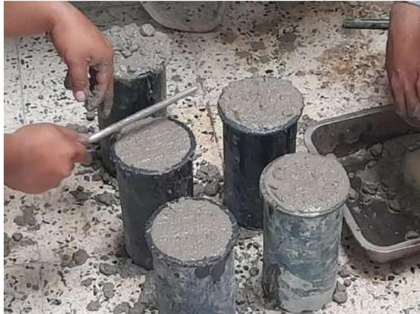
**Figura 7. Curado de probetas**
