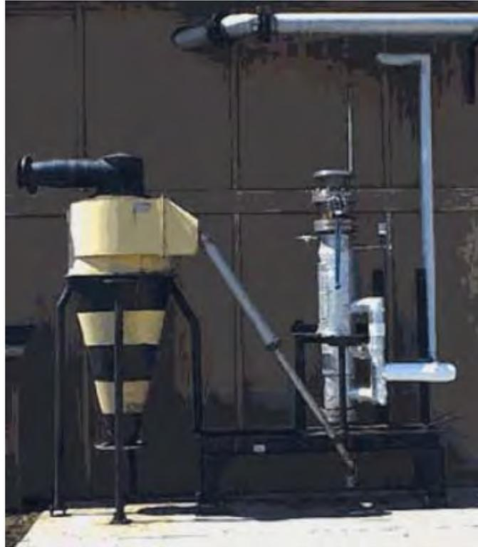
**Figura 49.** Sistema de explosión de vapor en Virginia Tech.
