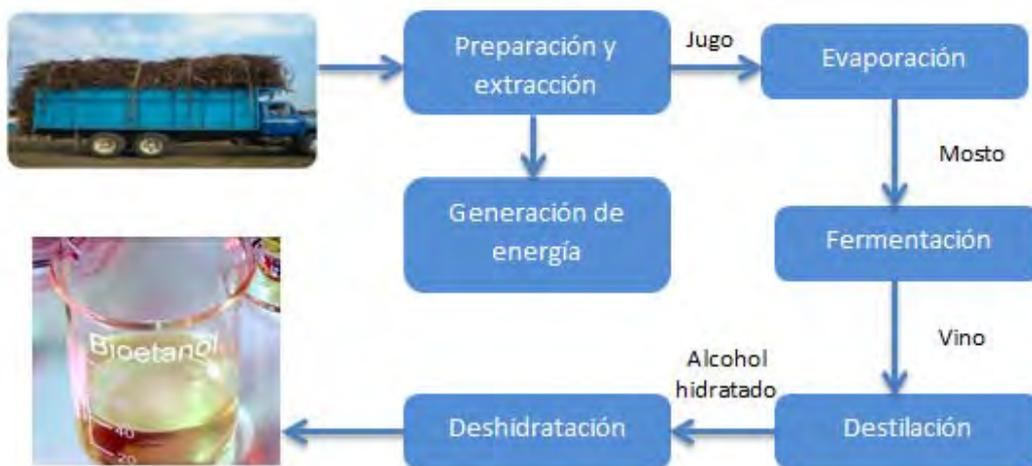
**Figura 4.** Diagrama de flujo del proceso productivo de bioetanol a partir de caña de azúcar - Caña Brava.
