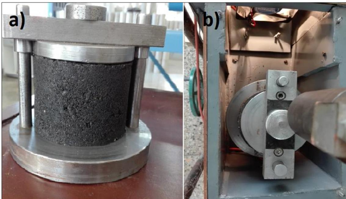
**Figura 11.** Ensayo Creep realizado en LEMC. a) Mordazas que permiten ejecución de carga a compresión uniaxial y b) Probeta colocada para ejecutar cargas en cámara bajo 40°C.
