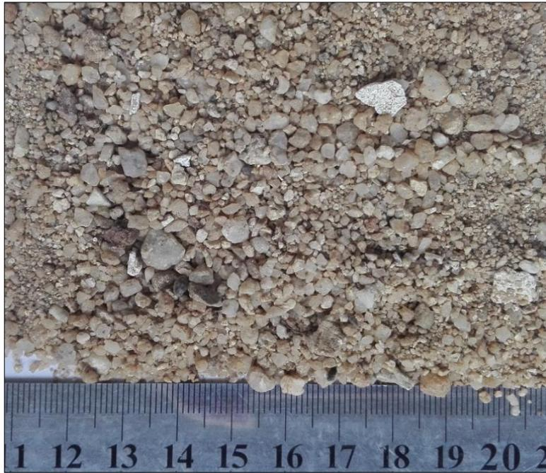
**Figura 18.** Agregado fino proveniente de la Cantera Cerro Mocho, usado en la presente investigación.
