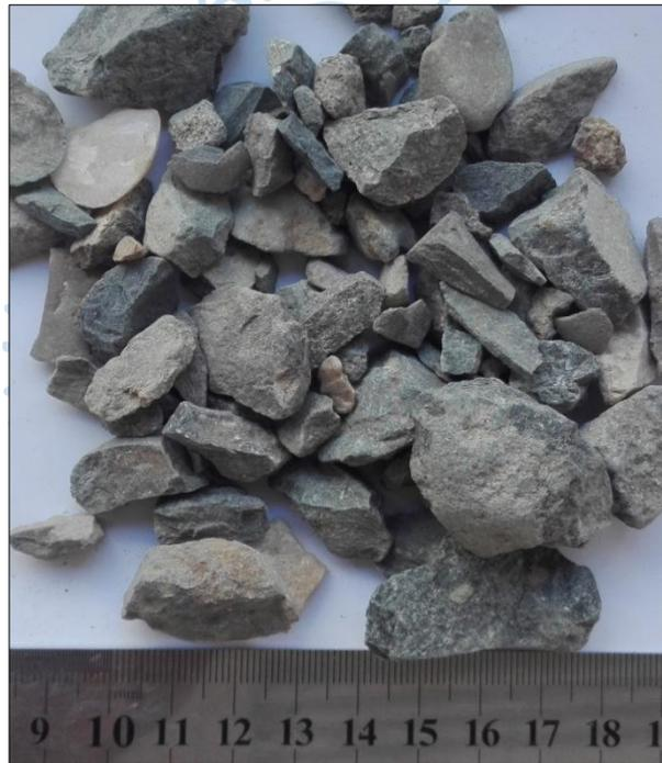
**Figura 16.** Agregado grueso de la cantera Sojo.
