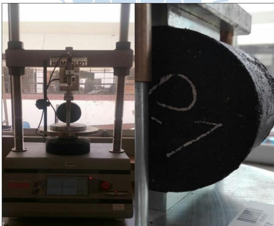
**Figura 14.** Especimen en la máquina de prueba en el laboratorio en condiciones secas
