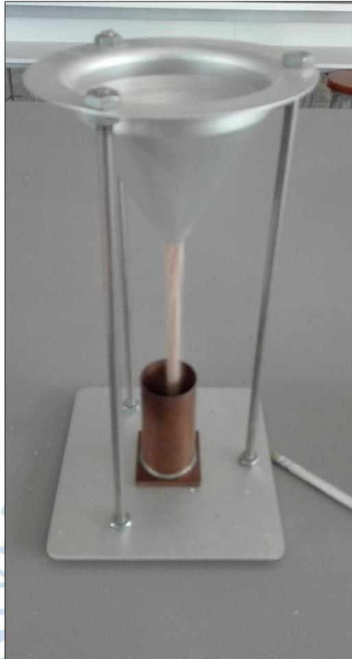
**Figura 8.** Ensayo de angularidad, en equipo indicado según AASHTO T 304
