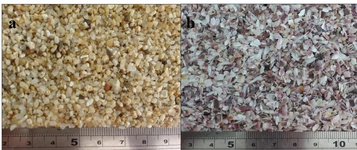
**Figura 23.** Agregados que pasan el tamiz N°8 y se retienen en el tamiz N° 16: a) agregado natural y b) valva triturada
