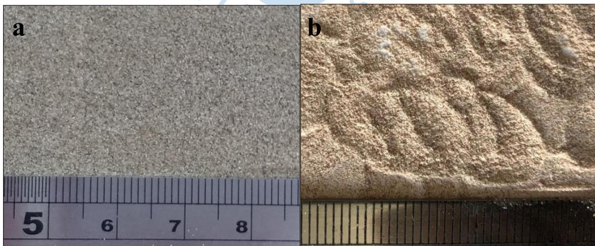
**Figura 27.** Agregados que pasan el tamiz N° 100 y retienen en el N° 200: a) agregado natural y b) valva triturada.
