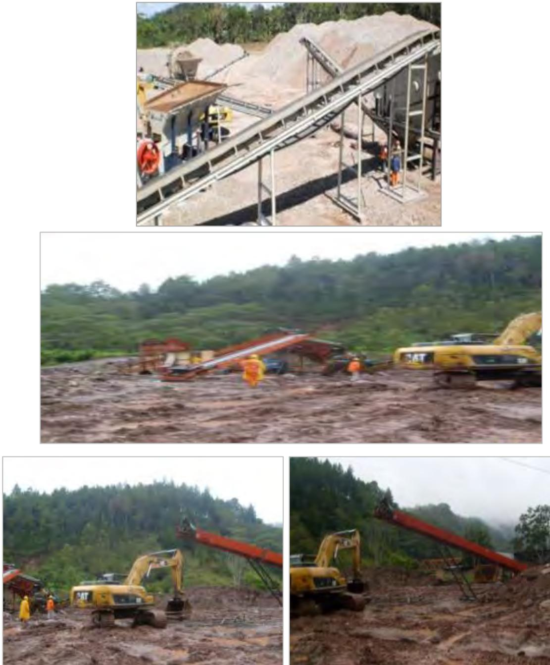
**Fig.3.16: Instalación de plantas industriales para el procesamiento de agregados**
