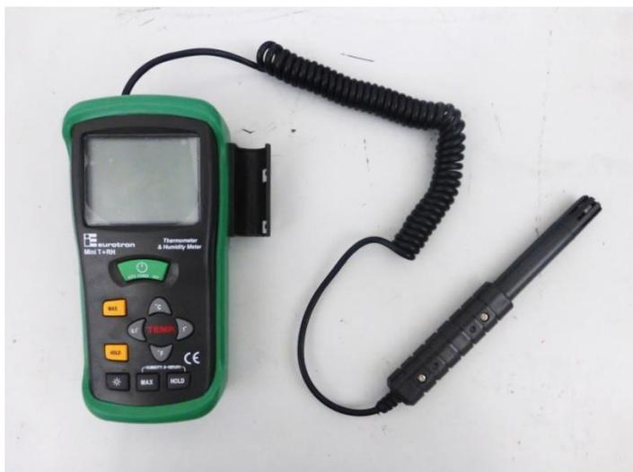
**Figura 3.13 - Higrómetro Mini T-RH.**
