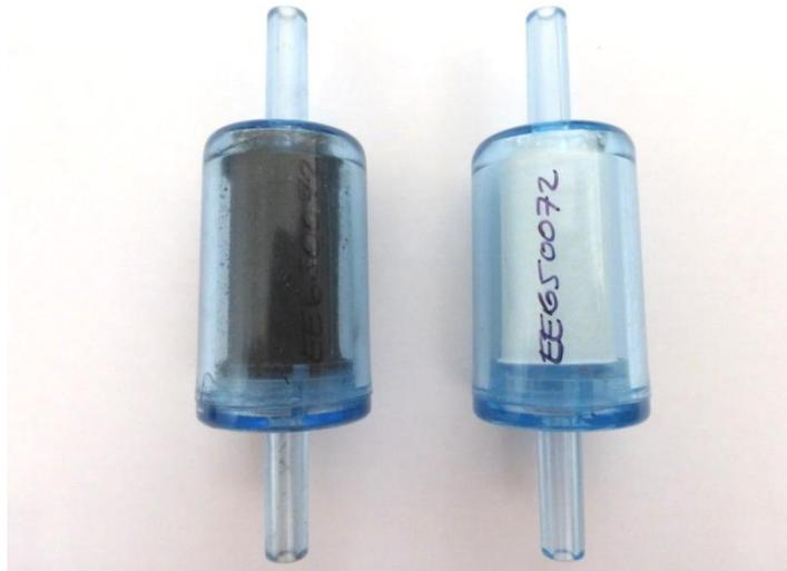
**Figura A.2 – Filtros de aire. A la derecha, el filtro nuevo.**
