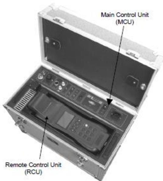
**Figura 3.1 - Analizador de gases GreenLine 8000.**
