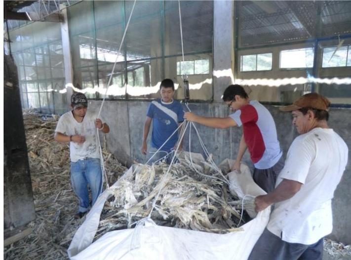
**Figura 3.14 - Llenado de la lona con el bagazo combustible.**
