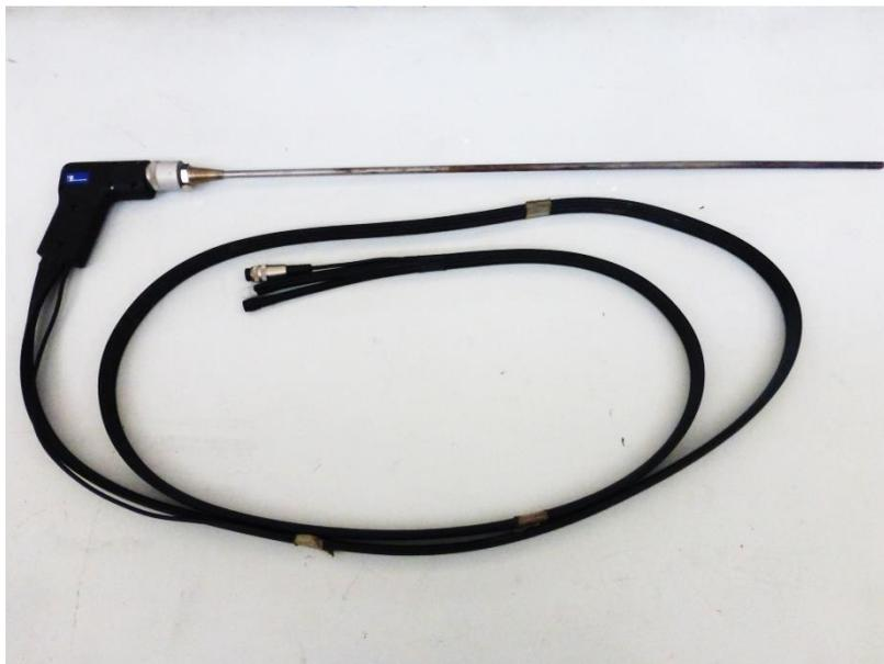
**Figura 3.4 - Sonda de análisis de gases.**
