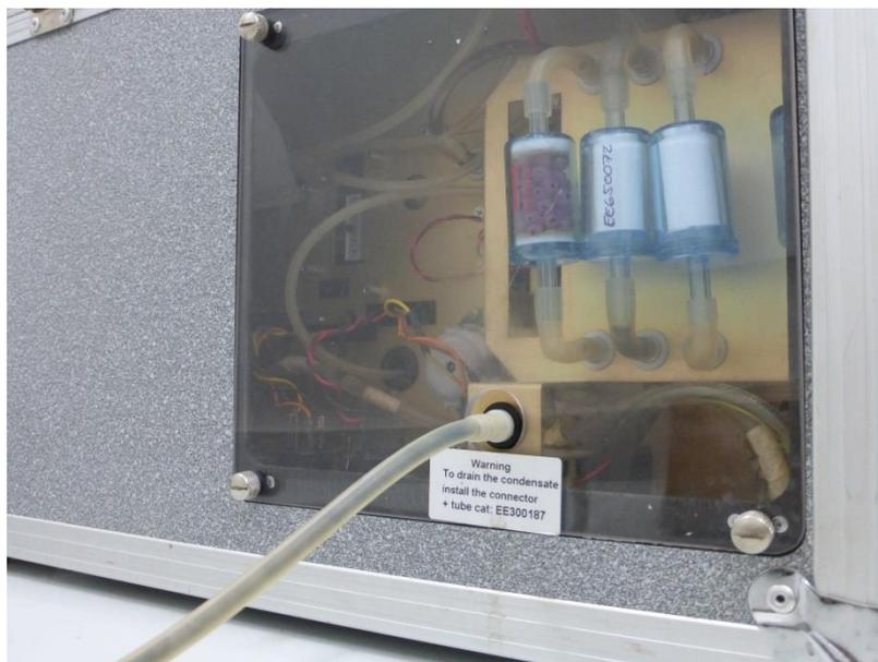
**Figura 3.8 - Conexión de la manguera de evacuación de condensados.**
