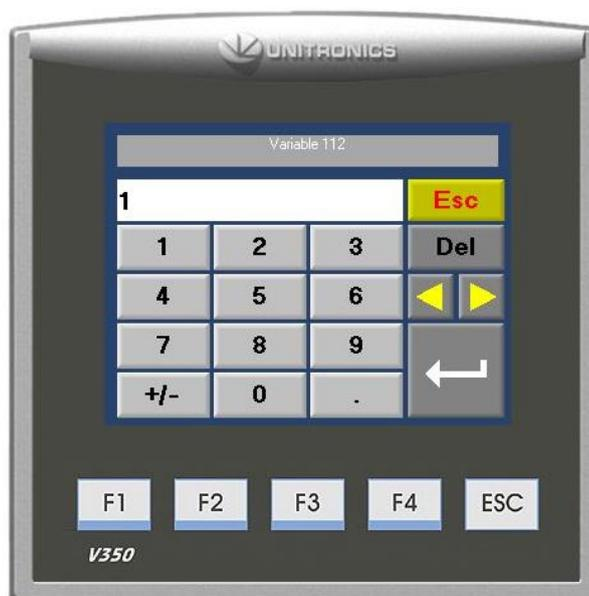
**Figura F.11 - Pantalla Registro del HMI - Ingreso de valores: periodo y duración.**
