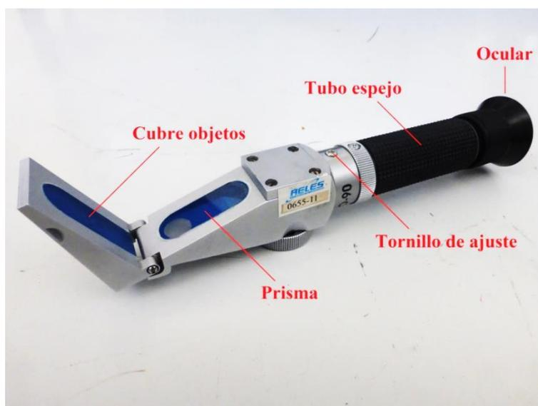
**Figura 3.12 - Partes de un refractómetro portátil.**
