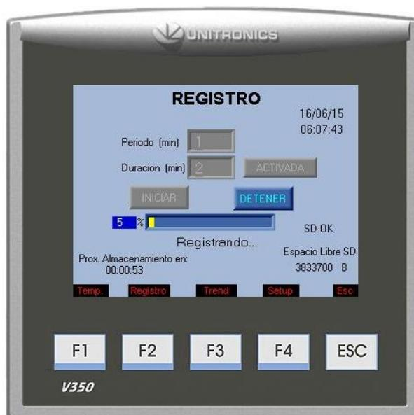
**Figura F.12 - Pantalla Registro del HMI - Registrando con periodo y duración.**
