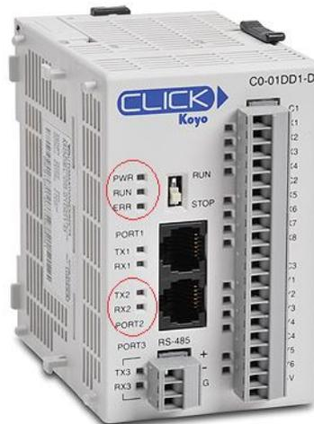
**Figura F.3 - PLC para adquisición de datos.**
