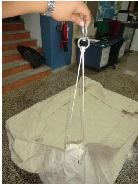
**Figura G.3 - Conexión de anillos de metal – driza – orejas del bolso de lona.**
