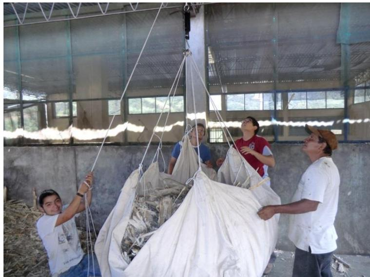
**Figura 3.15 - Alza de la lona con el bagazo combustible.**
