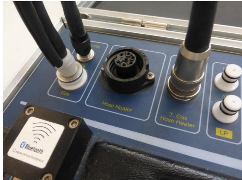
**Figura 3.6 - Conexión de la sonda de análisis de gases.**
