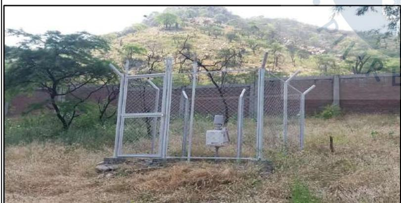
Foto 1. Estación Pluviométrica automática Qda. El carrizo
