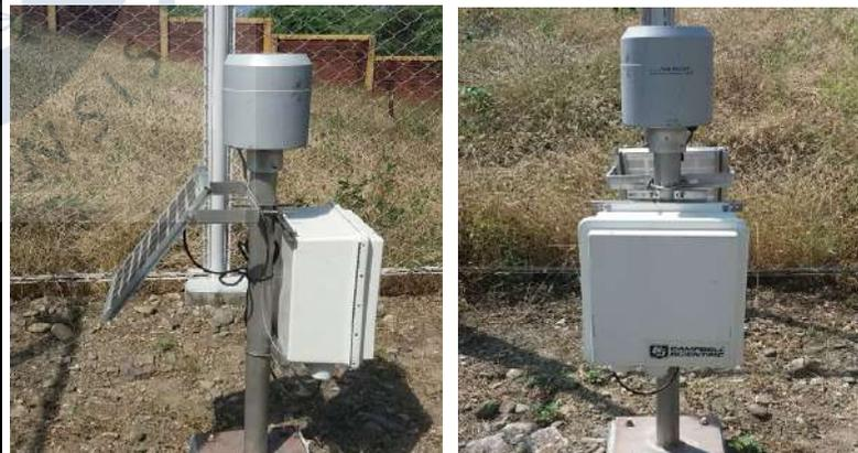
Foto 2. Pluviómetro automático
