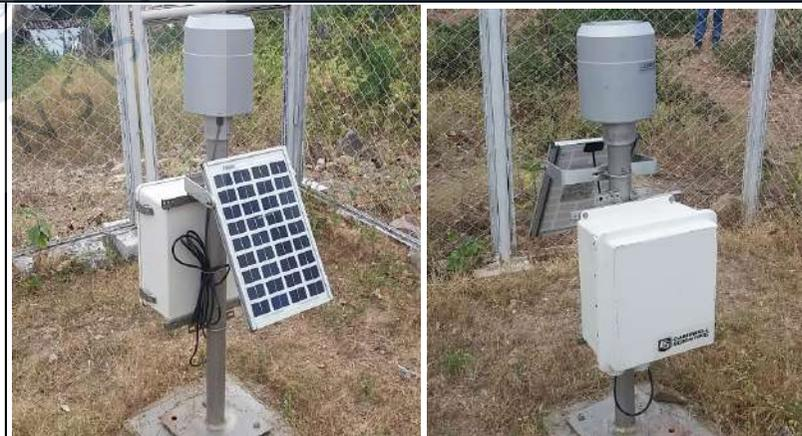
Foto 2. Vistas pluviómetro automatico
