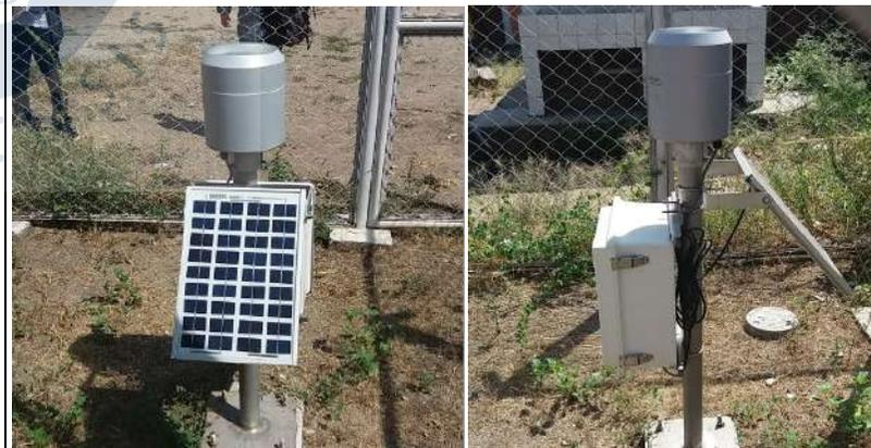
Foto 2. Condiciones Pluviómetro automático
