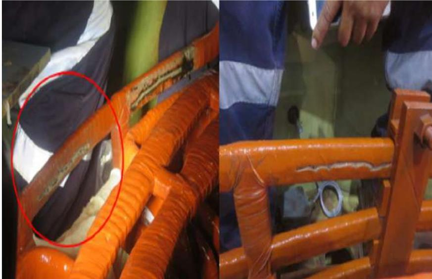
Figura 46. Aislamiento cristalizado en el puente de bobina
