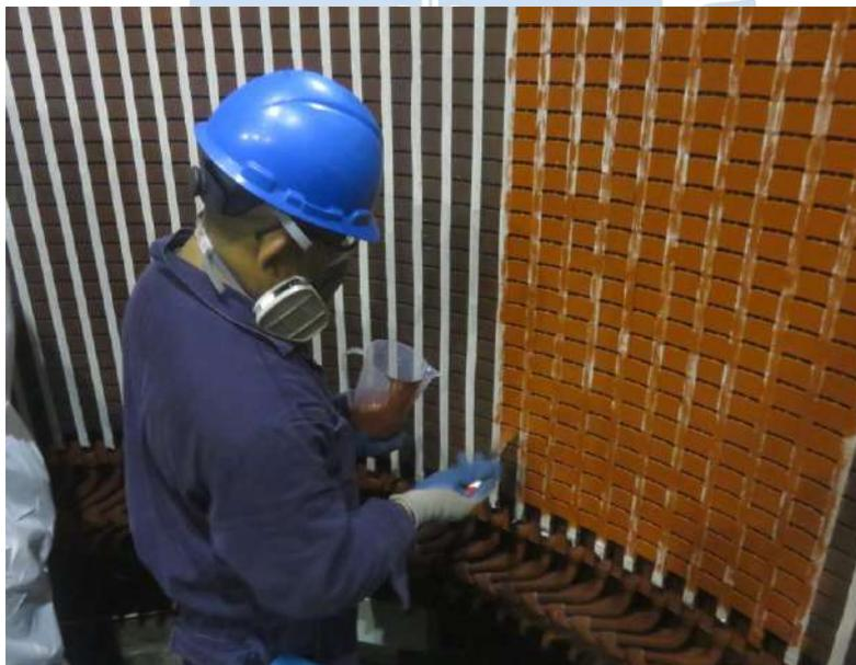
Figura 54. Aplicación de Antiflash Damicoat 2407
