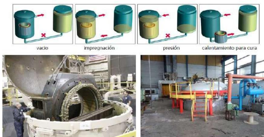
Figura 40. Ejemplos de impregnación de resina por Global VPI
