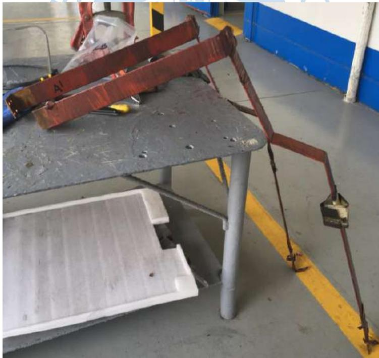
Figura 47. Barras de conexiones con aislamiento envejecido
