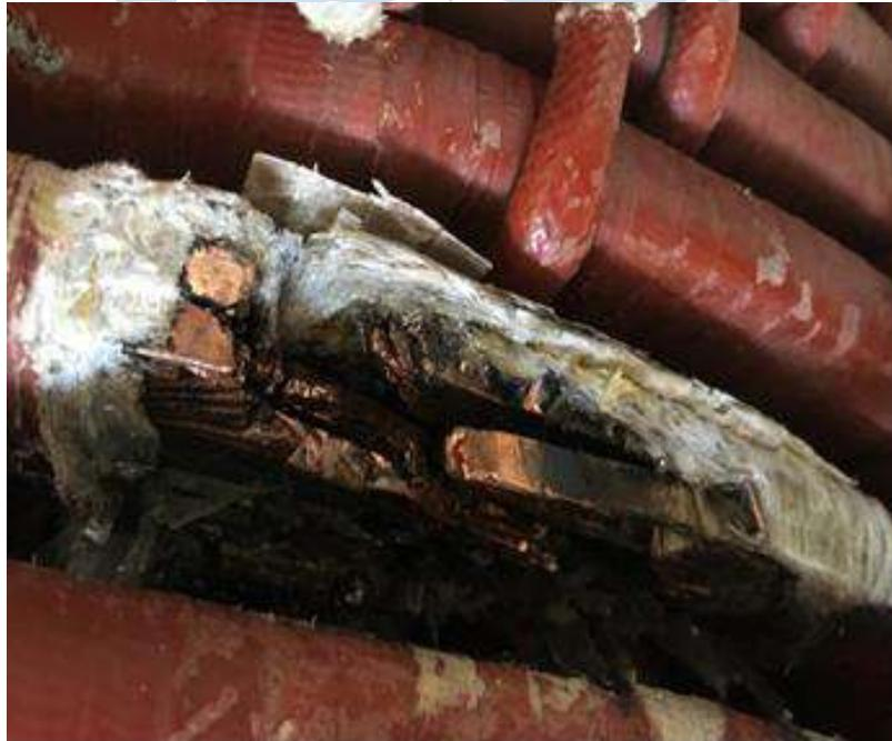
Figura 60. Bobina dañada.
