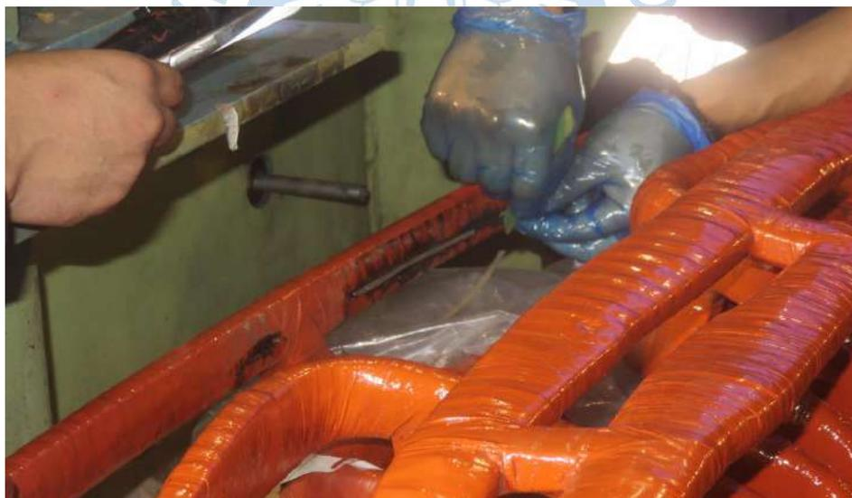
Figura 52. Curación de aislamiento cristalizado en puente de bobinado
