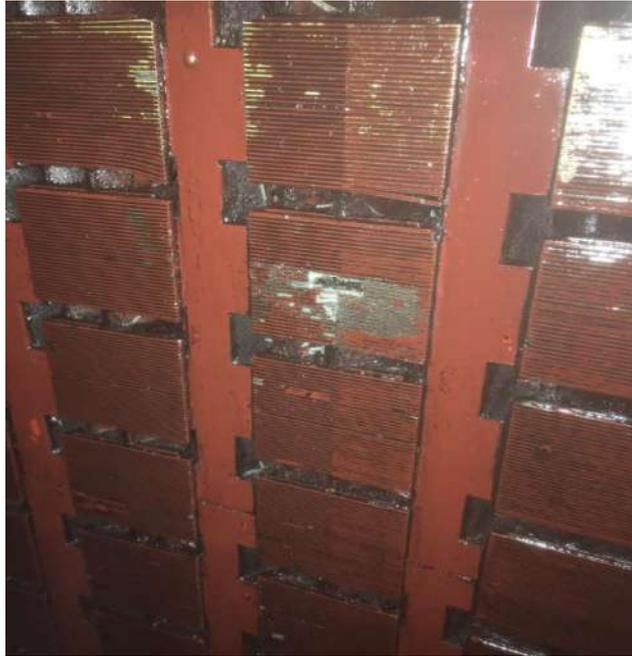
Figura 48. Conductos de ventilación contaminados
