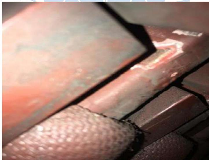
Figura 45. Descarga parcial en la bobina 24
