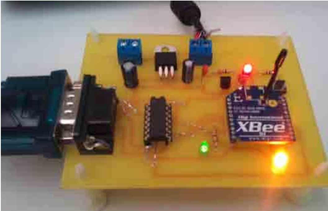
**Foto AI.11. Diodo led verde encendido, representando la recepción de los datos inalámbricamente.**
