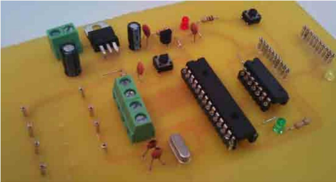
**Foto AI.3. Tarjeta de transmisión de datos, sobre el cual se monta el módulo de transmisión inalámbrica XBee.**
