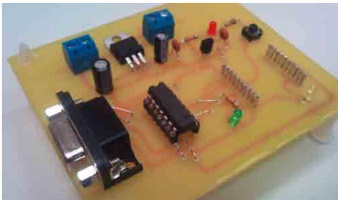
**Figura 3.15. Tarjeta de recepción de datos**
