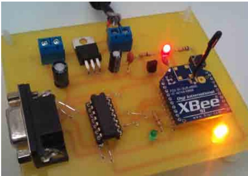
**Foto A1.7. Tarjeta de recepción de datos alimentada a 5V**
