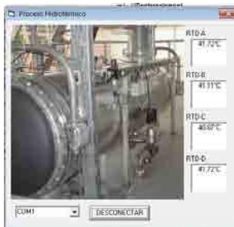
**Figura AVI.5. Temperatura en Visual Basic en prueba de comunicación**
