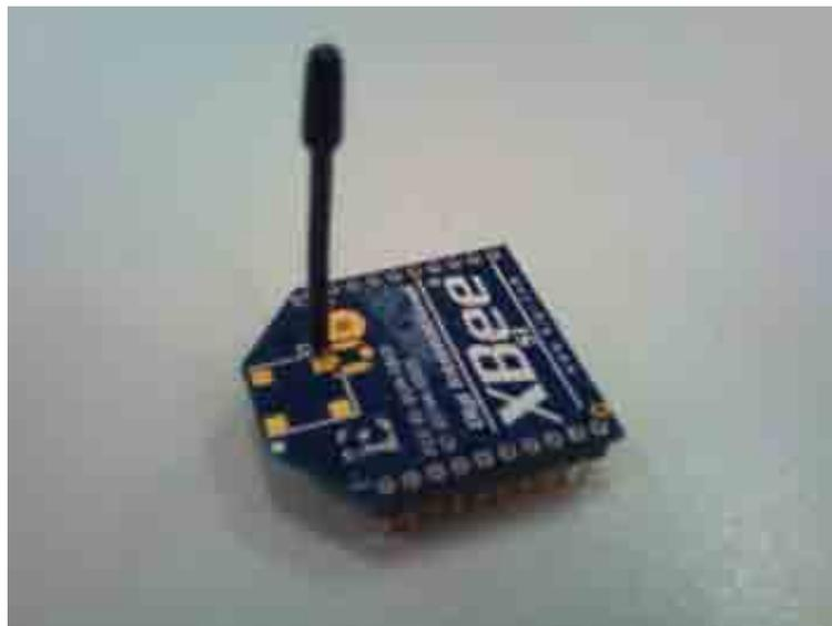
**Foto AI.2. Módulo de transmisión inalámbrica XBee, el cual nos permite comunicar bajo el protocolo ZigBee.**
