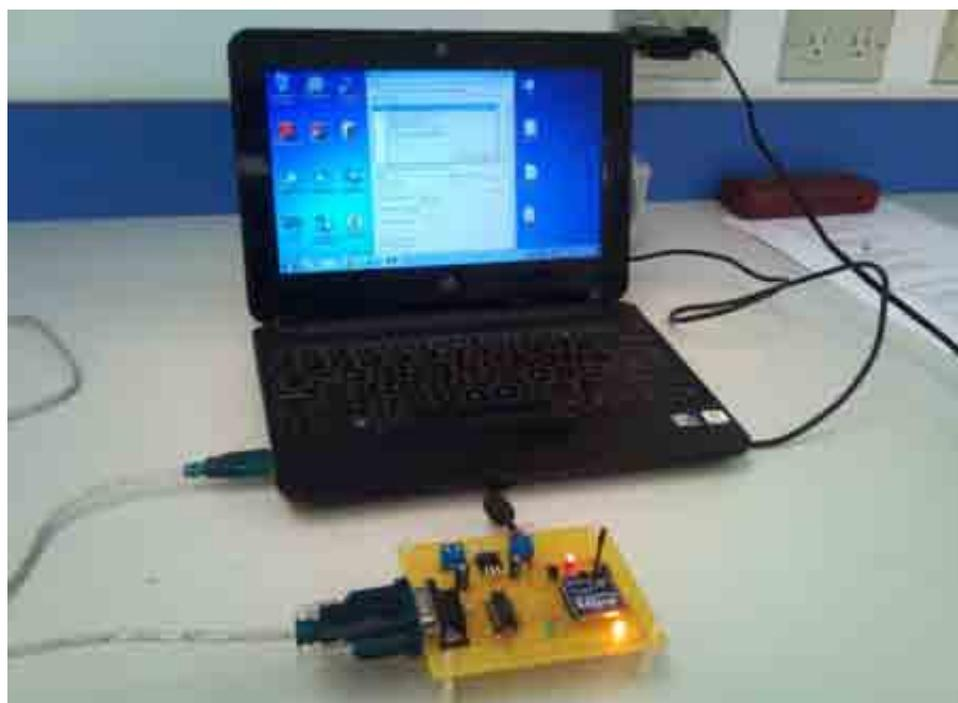
**Foto A1.8. Tarjeta de recepción de datos conectada a la computadora.**
