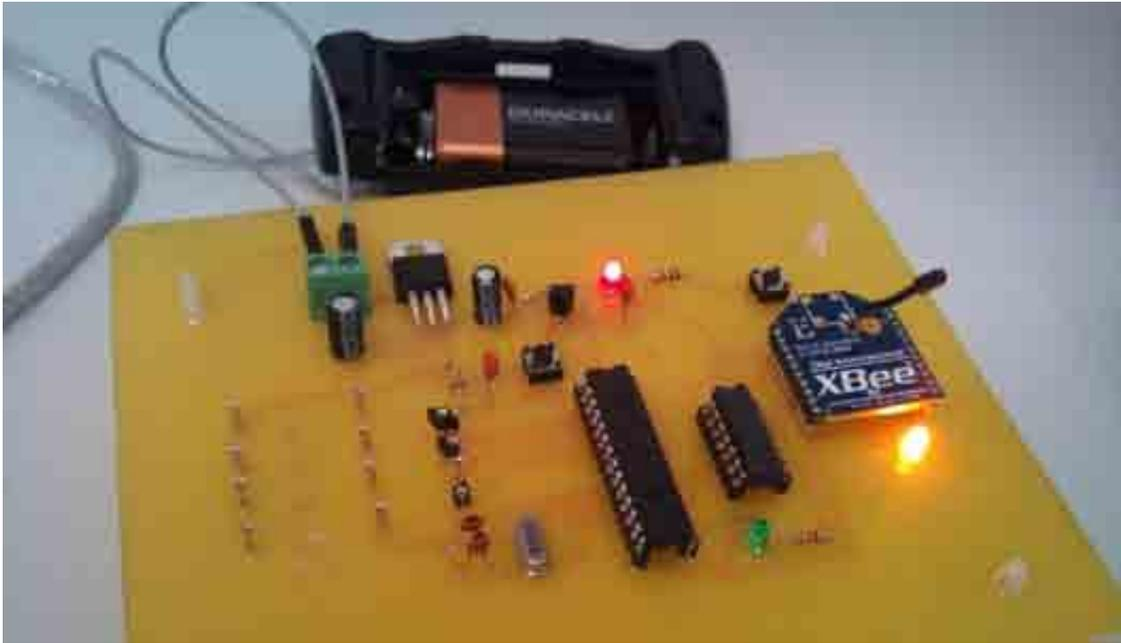
**Foto AI.9. Tarjeta de transmisión de datos alimentada con una pila de 9V.**
