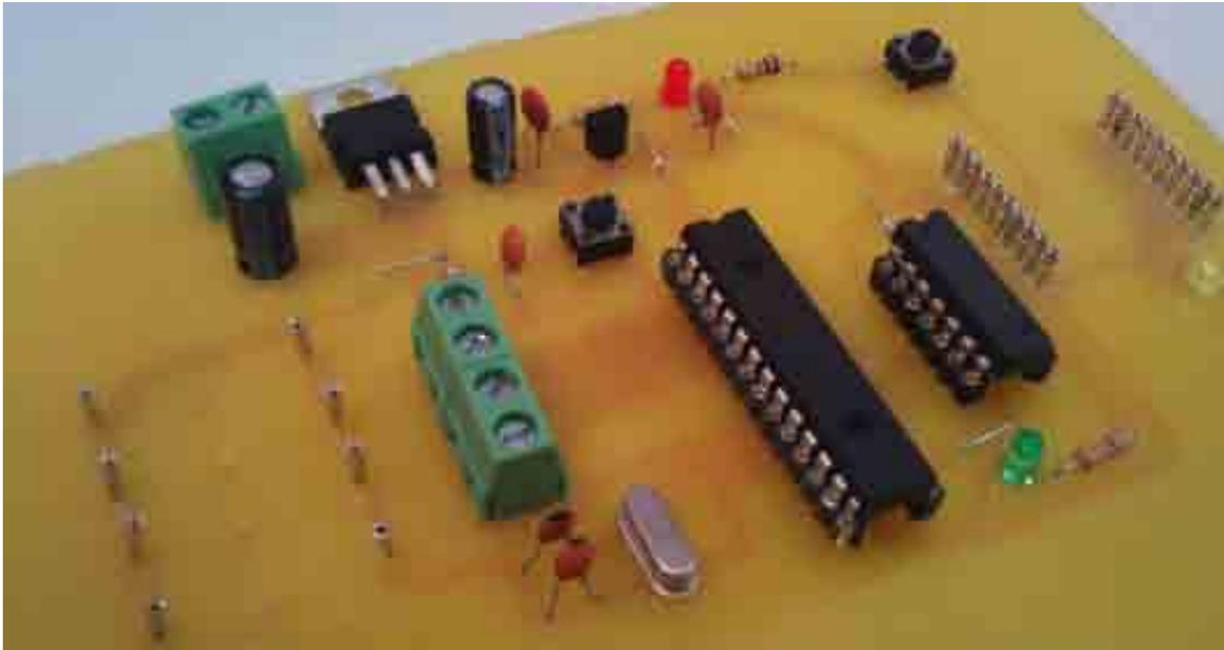
**Figura 3.10. Tarjeta de transmisión de datos**
