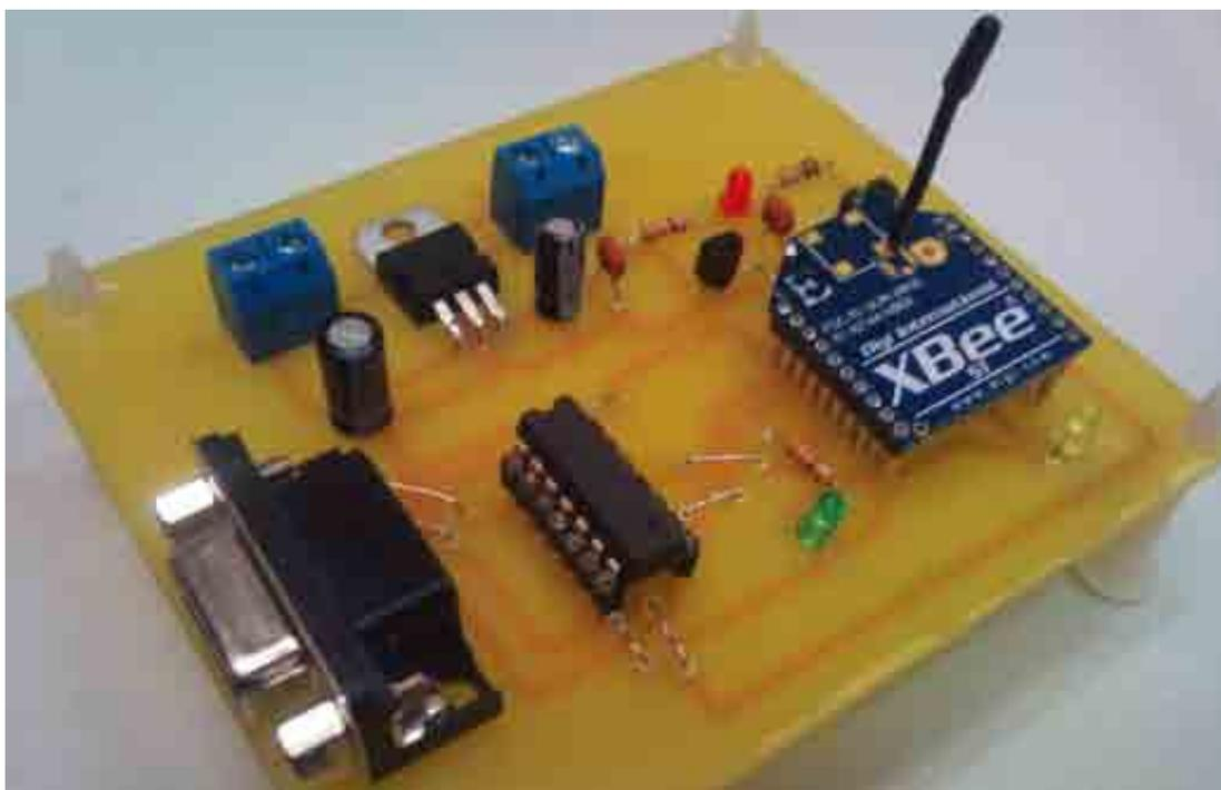
**Figura 3.18. Modulo XBee, montado sobre la Tarjeta de recepción de datos**
