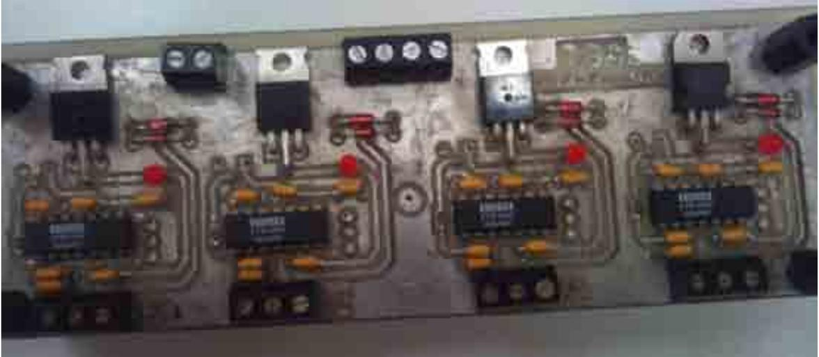
**Foto AI.1. Tarjeta acondicionadora de señal de 4 – 20mA, donde se conecta el sensor de temperatura (RTD).**
