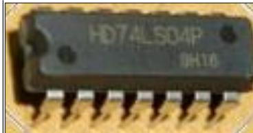
**Figura 3.17. Circuito integrado 74LS04**
