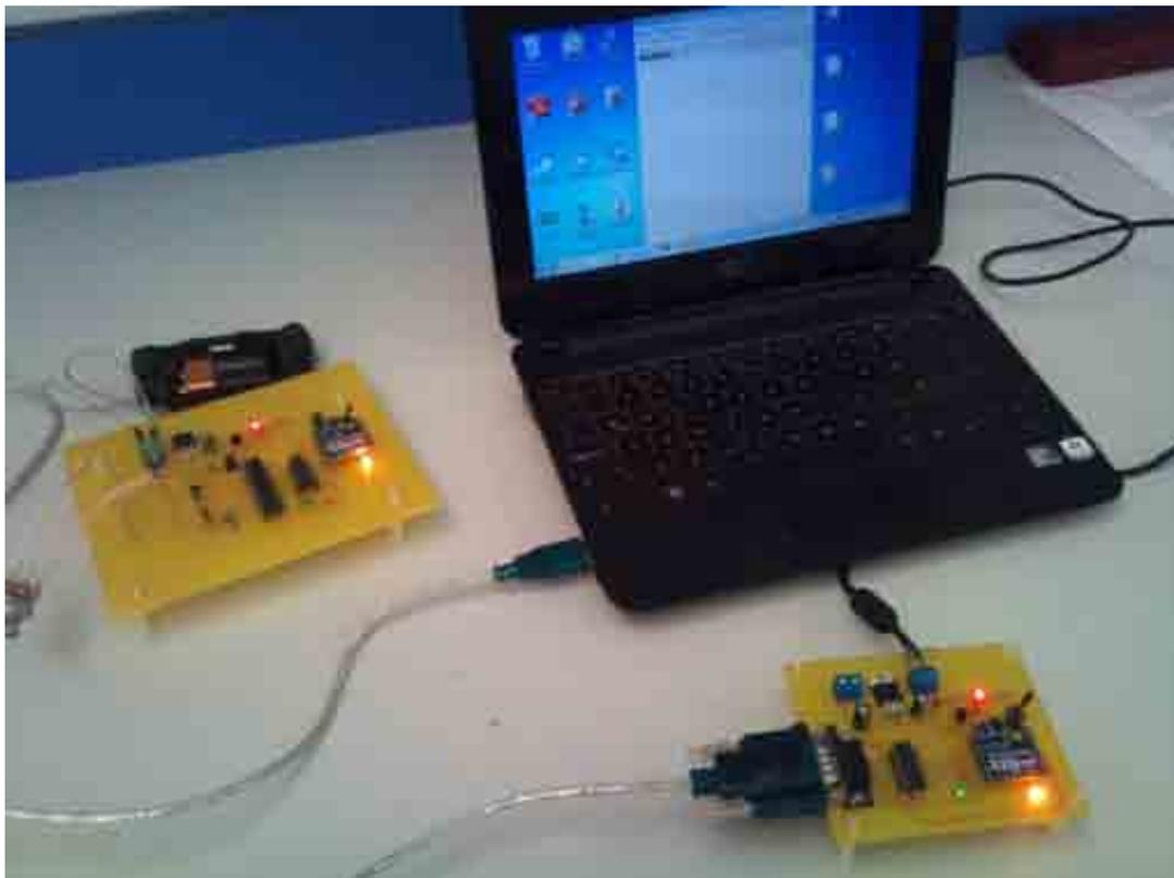
**Foto AI.10. Prueba de transmisión inalámbrica de temperatura con el potenciómetro.**
