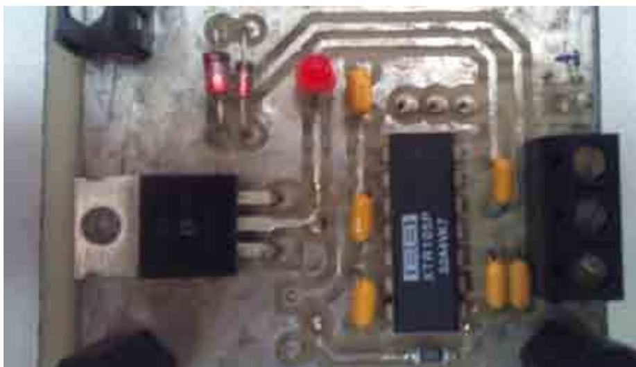
**Figura 3.9. Tarjeta acondicionadora de señal de 4 a 20 mA**
