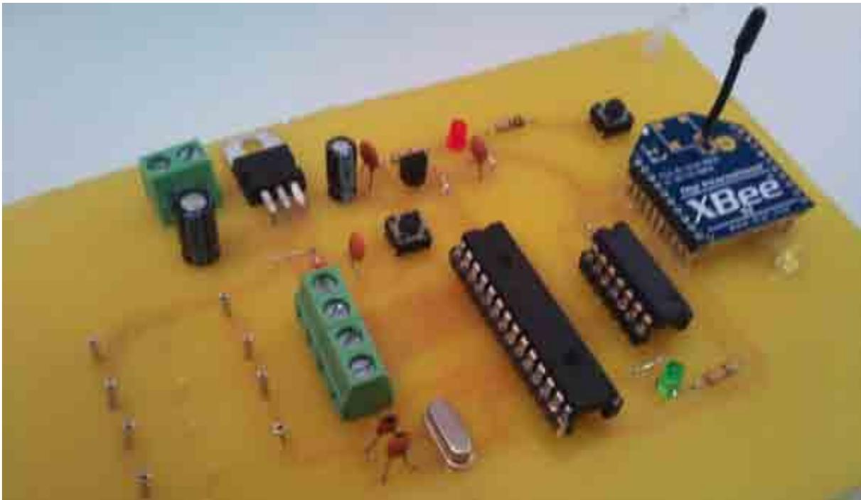
**Figura 3.14. Modulo XBee, montado sobre la Tarjeta de transmisión de datos**
