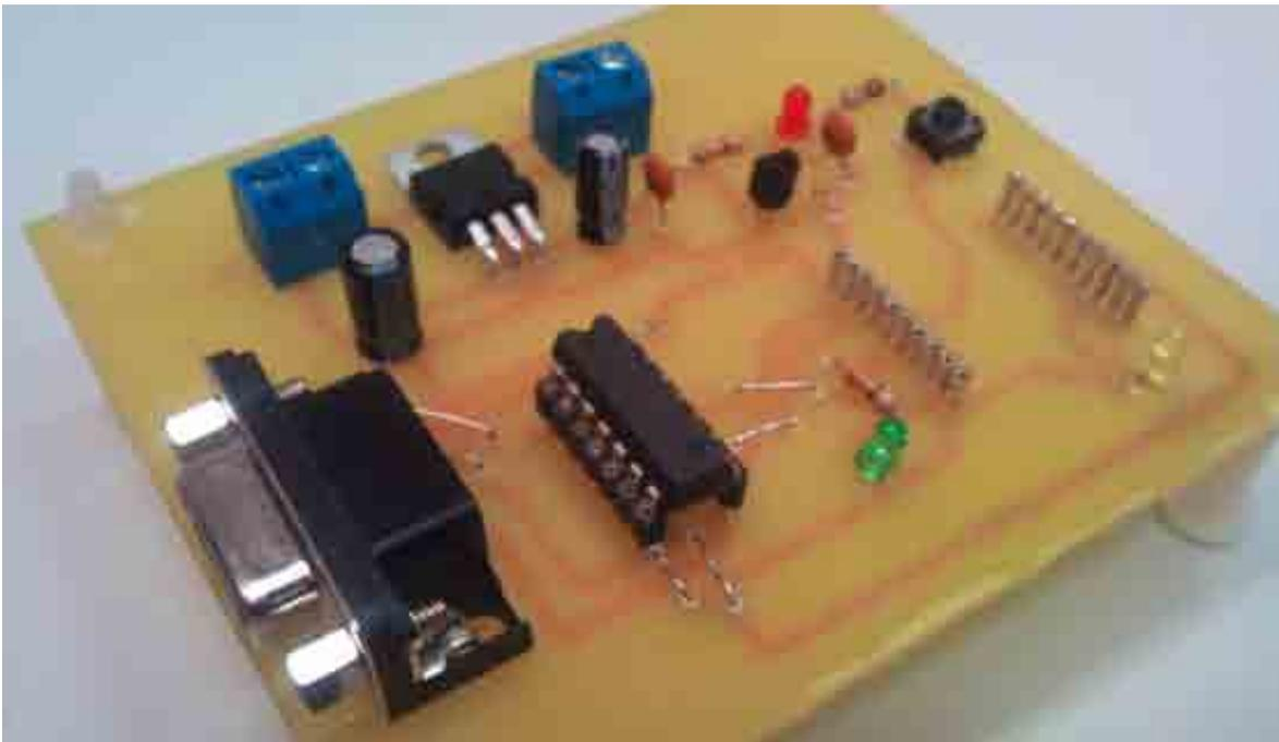
**Foto AI.4. Tarjeta de recepción de datos, el cual sirve como interfaz entre el XBee y el procesador (para este caso una PC), sobre el cual se monta el módulo de transmisión inalámbrica XBee.**
