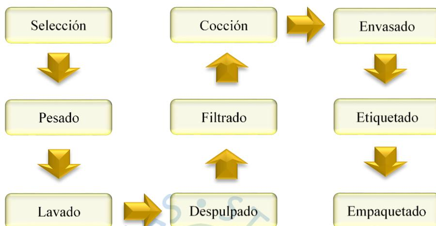
Figura 6. Flujograma del proceso de la elaboración de mermelada de mango ciruelo
