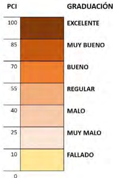
**Figura 27.** Escala de graduación del Índice de Condición del Pavimento.
