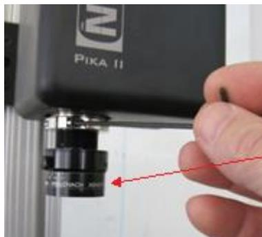
**Figura 21 Calibración Mecánica del lente.**
