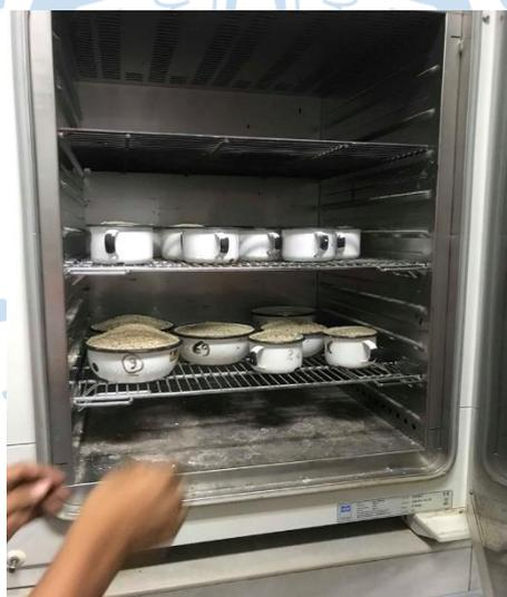
**Figura 22.** Introducción de la arena en el horno.
