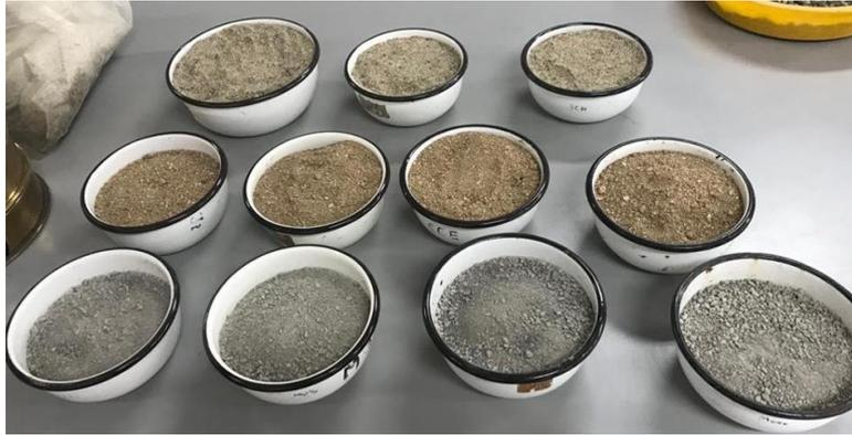
**Figura 23.** Arena de las diferentes canteras sacadas del horno
