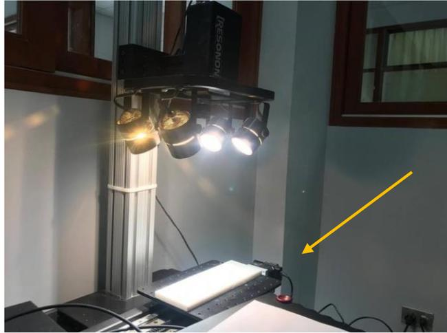
**Figura 31.** Faja transportadora de la Cámara Hiperespectral
