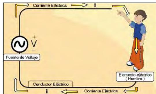
Figura 1.2.<sup>2</sup> Circuito de corriente 2, recorrido de corriente por el cuerpo humano
