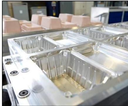
Figura 68. Moldes de termoformado
