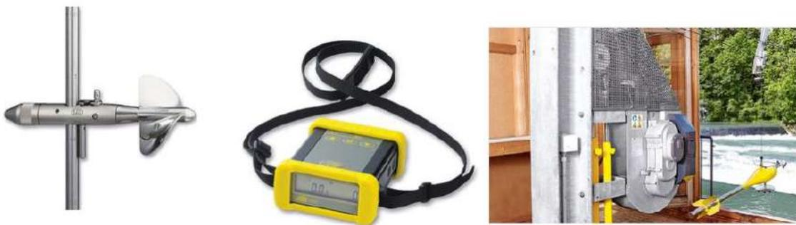
**Figura 18.** Correntómetro y accesorios.
