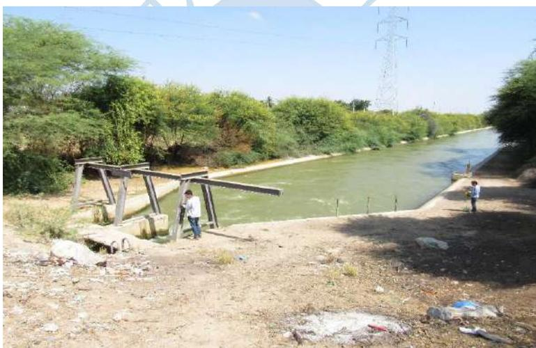
**Figura 23.** Aforo en la salida del sifón.
