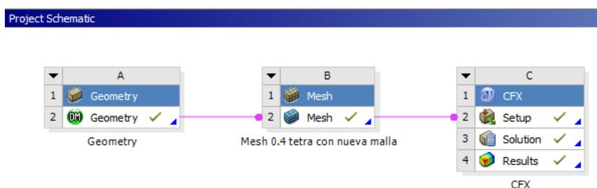
**Figura 32.** Esquema final de nuestro proyecto en Ansys *workbench*.
