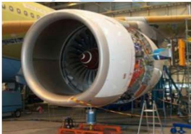
Figura 14. Distribución por posición fija: ensamble de un avión.
