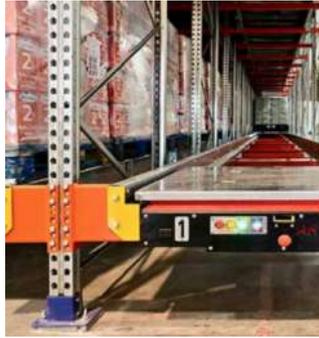
Figura 9. Carro satélite de pallets shuttle
