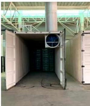
Figura 27. Cámara de gasificado.
