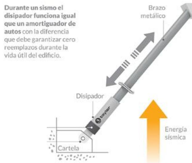
Figura A3. Disposición diagonal. Fuente: CDV Perú, 2012.
