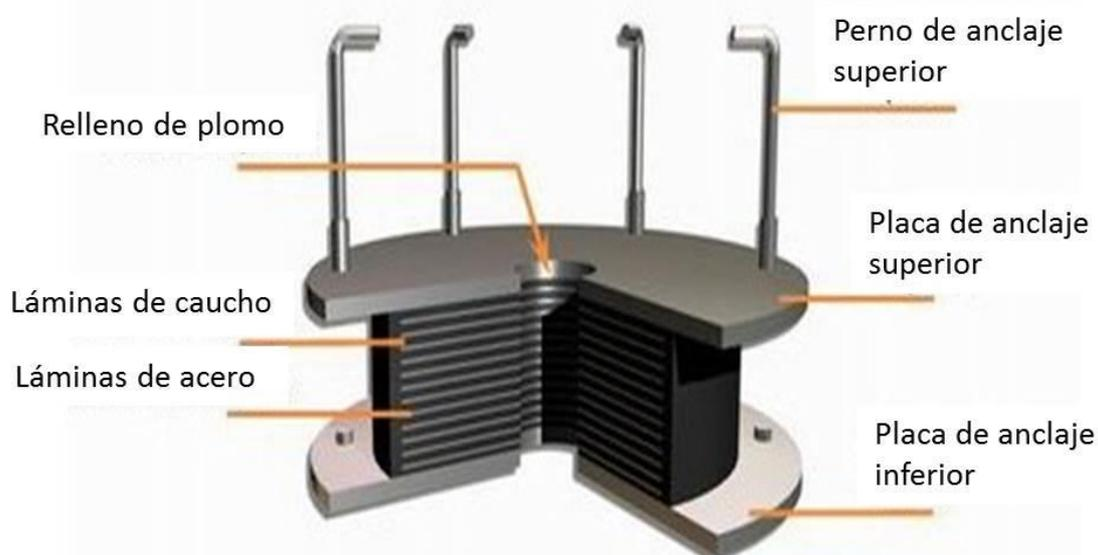
Figura 1.4. Aislador elastoméricos con núcleo de plomo. Fuente: *Dynamic Isolation Systems*, 2007.
