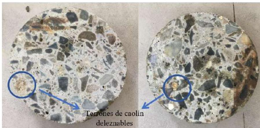
**Figura 24. Distribución de agregados en disco de probeta de concreto con reemplazos de caolín.**
