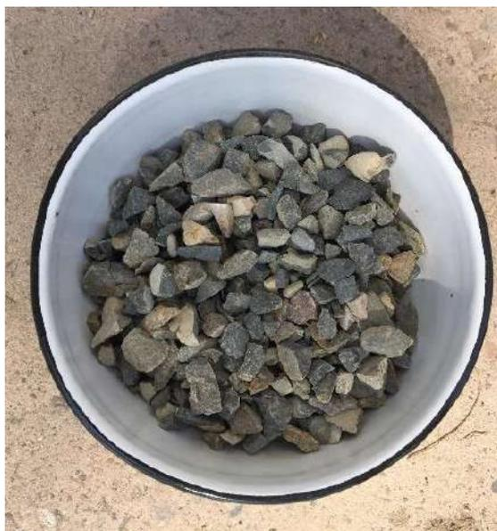
**Figura 7. Muestra de agregado grueso triturado.**
