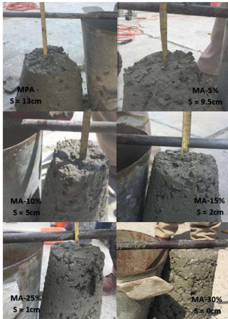
**Figura 20. Resultado de ensayo de cono de Abrams**
