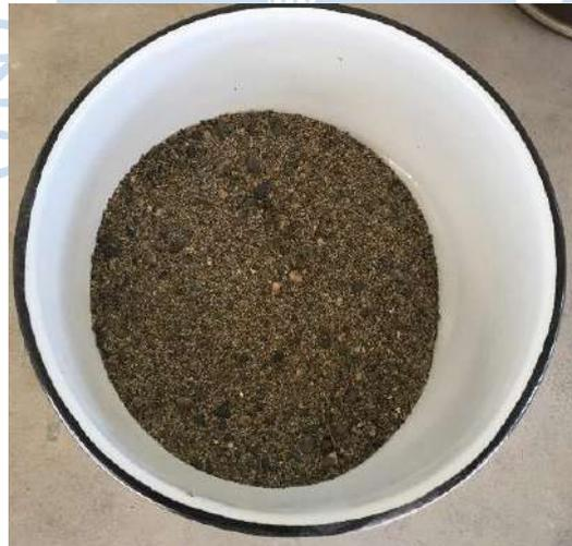
**Figura 10. Muestra de agregado fino.**
