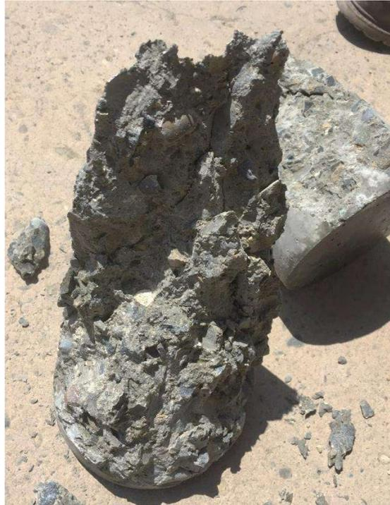
**Figura 27. Probeta MA-15% después del ensayo a la compresión.**
