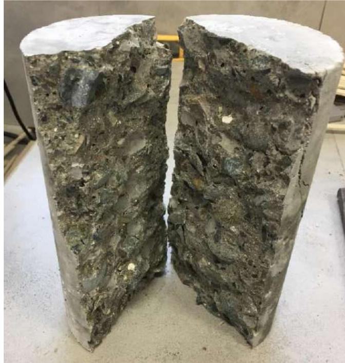
**Figura 29. Rotura de probeta de diseño MA-15%.
