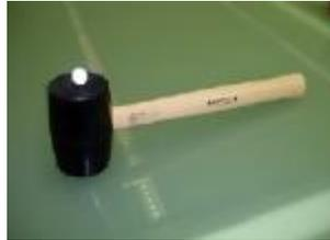
*Figura 57 Mazo utilizado para la sincronización de cámaras y placas de fuerzas.*
