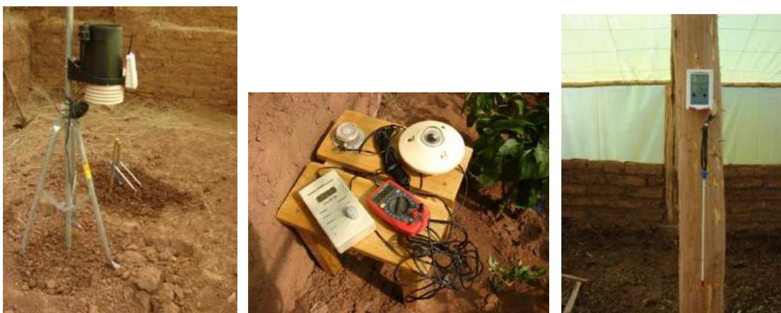
**Figura 43** a. Estación Davis b. Solarímetro y radiómetro c. Termómetros
