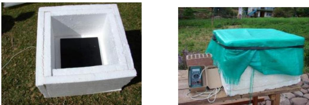
**Figura 42.** Caja térmica y medida de la temperatura de placa
