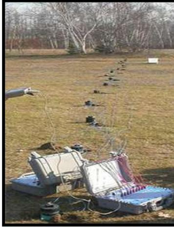
**Figura 5.** Distribución de electrodos para realizar una sección.
