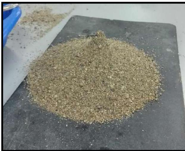
**Figura 10.- Agregado fino de la cantera Chulucanas**
