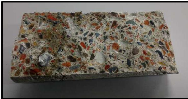
Figura 30.- Rotura del concreto con un 20% de reemplazo de ladrillo La Huaca.
