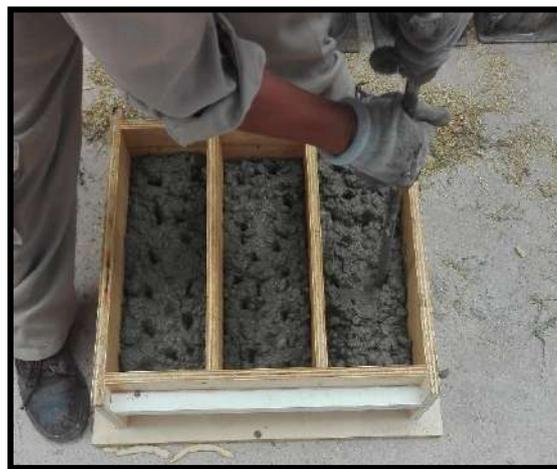
**Figura 20.- Compactación de los especímenes para el ensayo de flexión.**
