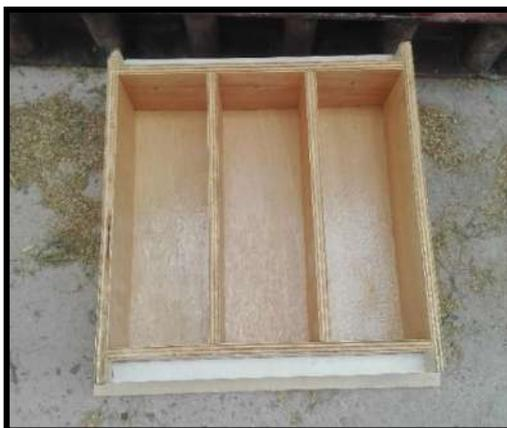
**Figura 19.-Moldes para elaborar los especímenes del ensayo a flexión del concreto.**
