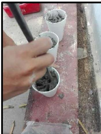
**Figura 21.- Compactación de especímenes en los moldes para las pruebas de absorción del concreto.**
