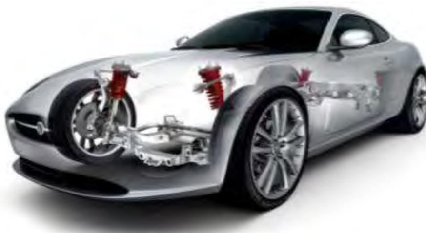
**Figura 1.** Sistema de suspensión delantera y trasera de un auto Jaguar XF.
