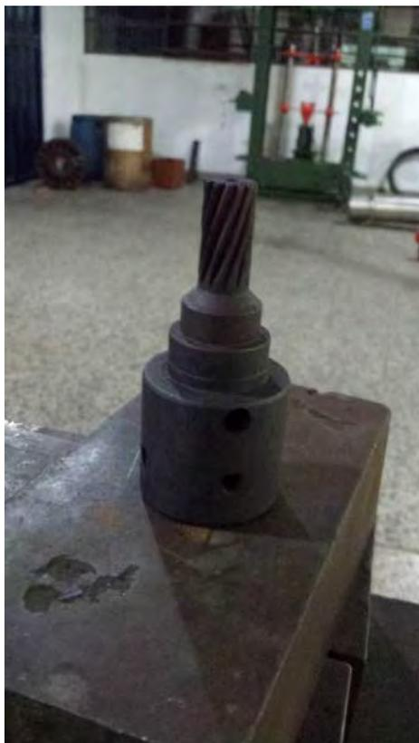
**Figura 79.** Acople terminado, listo para instalar en motorreductor.
