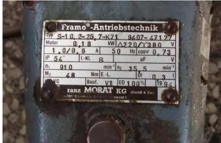
**Figura 75.** Motorreductor de 0.18 kW (910/48).
