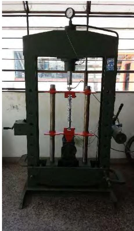
**Figura 81.** Banco de ensayo de amortiguadores – versión 3 final.
