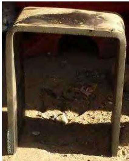
**Figura 67.** Base tipo U para tubo guía.
