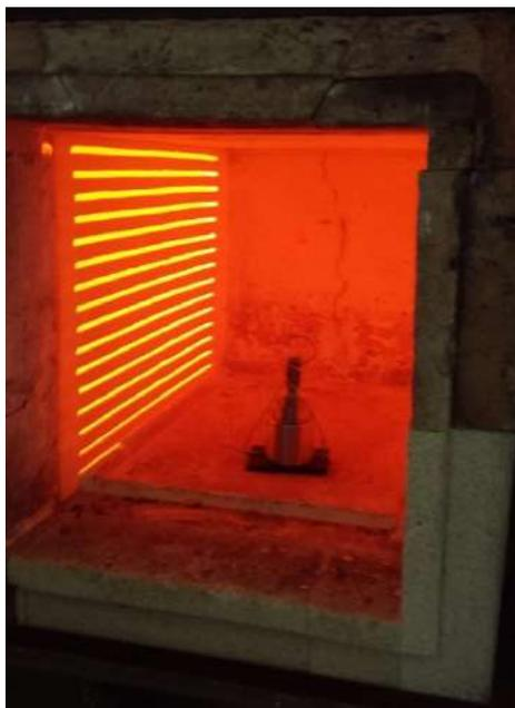
**Figura 78.** Tratamiento térmico de temple y revenido en acople fabricado para motorreductor.
