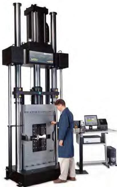
**Figura 53.** Bastidor de 1500 kN con mordazas acopladas para el ensayo de metales.
