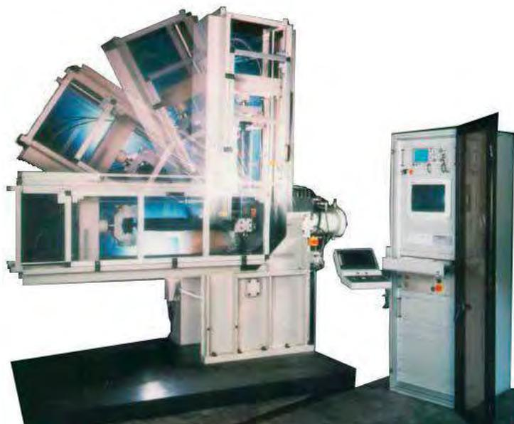
**Figura 54.** Banco de ensayo de amortiguadores basada en la MSP Standard Series de IST®.
