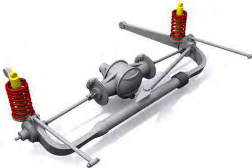
**Figura 19.** Esquema simplificado de una suspensión semirrígida con "Eje de Dion".
