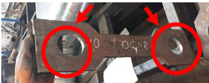
**Figura 64.** Carro superior (con agujeros guía) de banco de ensayo de amortiguadores.
