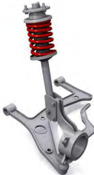
**Figura 21.** Esquema de una suspensión independiente de tipo McPherson.
