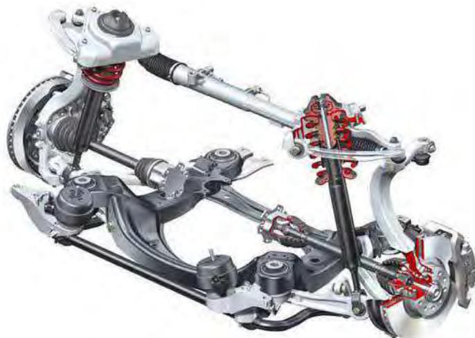
**Figura 27.** Sistema de suspensión multibrazo del eje delantero de un Audi A6.
