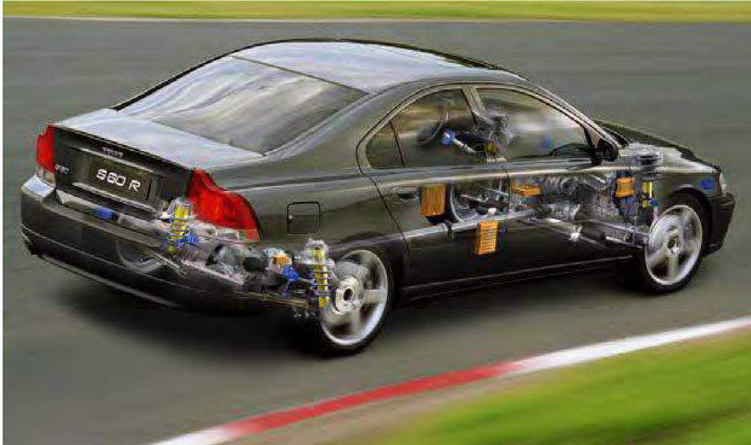
**Figura 32.** Sistema *Four-C* del Volvo S60 R.
