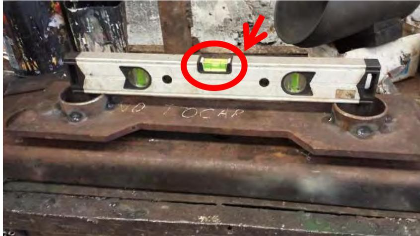
**Figura 66.** Verificación del correcto nivel de bocinas soldadas en carro superior e inferior.
