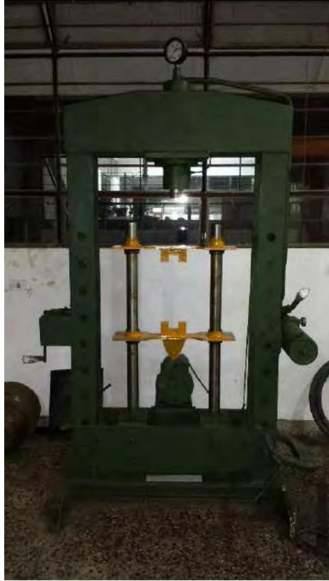
**Figura 80.** Banco de ensayo de amortiguadores – versión 2.
