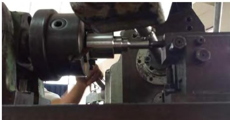
**Figura 77.** Proceso de fabricación de acople adaptador de motorreductor.
