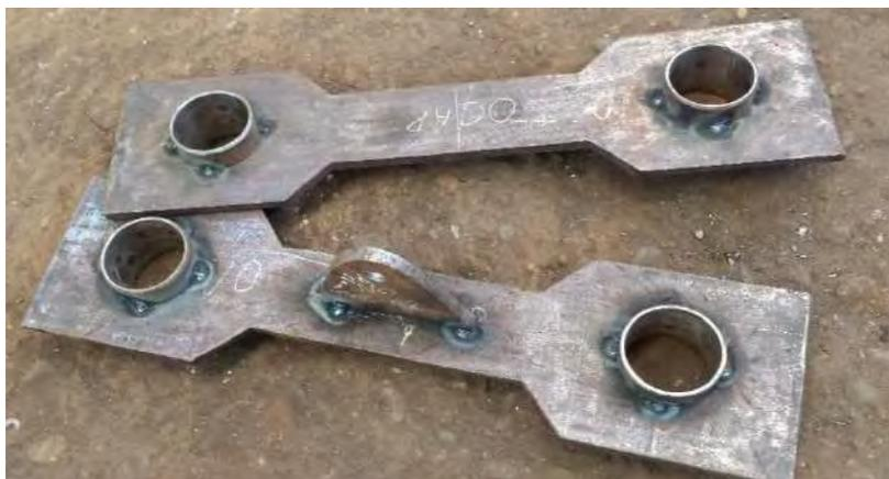
**Figura 65.** Carro superior (con bocinas soldadas) de banco de ensayo de amortiguadores.
