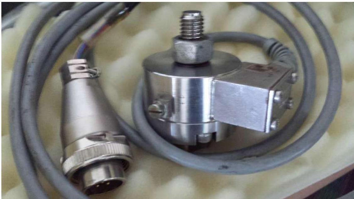
**Figura 94.** Celda de carga U2A - HBM.
