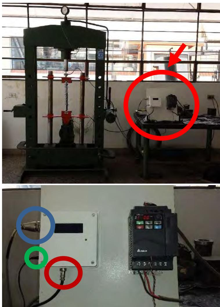
**Figura 82.** Banco de ensayo de amortiguadores – tablero accionamiento y de adquisición de datos.
