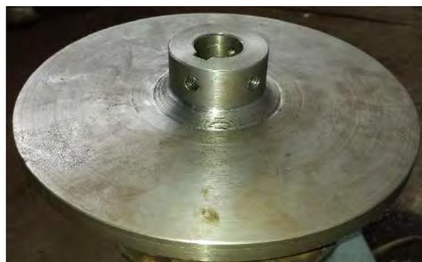
**Figura 71.** Rueda excéntrica preparada para mecanismo de transmisión de movimiento.
