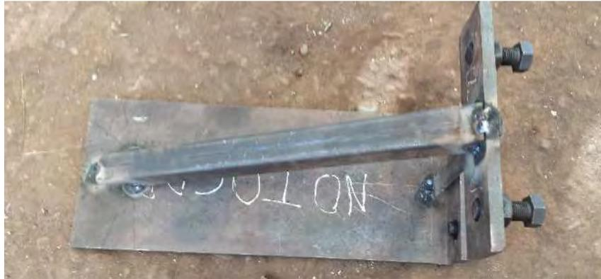
**Figura 72.** Soporte base de motor eléctrico empleado para generar el movimiento oscilatorio en el sistema.
