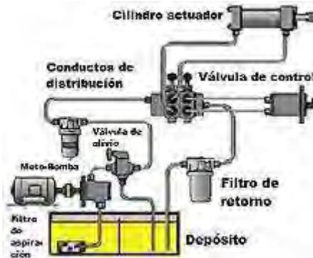
**Figura 59.** Esquema básico de un sistema hidráulico.
