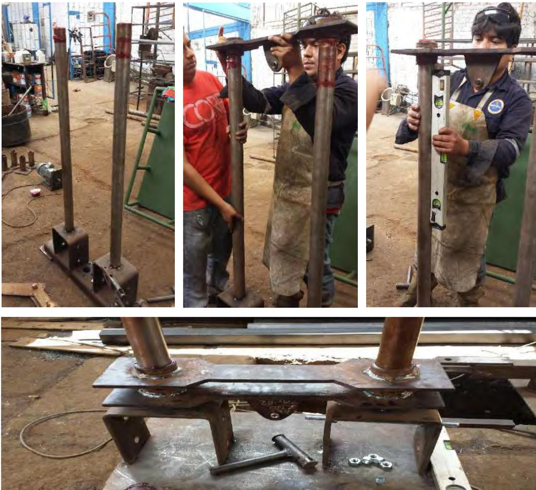
**Figura 73.** Presentación de piezas fabricadas y verificación de alineación correcta de tubos guía.
