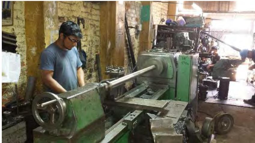
**Figura 68.** Refrentado de tubos guía en torno.
