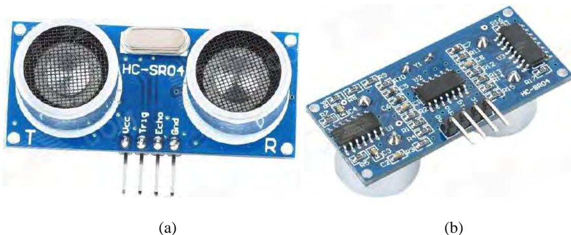
**Figura 88.** Vistas del sensor de ultrasonido HC -SR04: (a) Vista anterior (b) Vista posterior.
