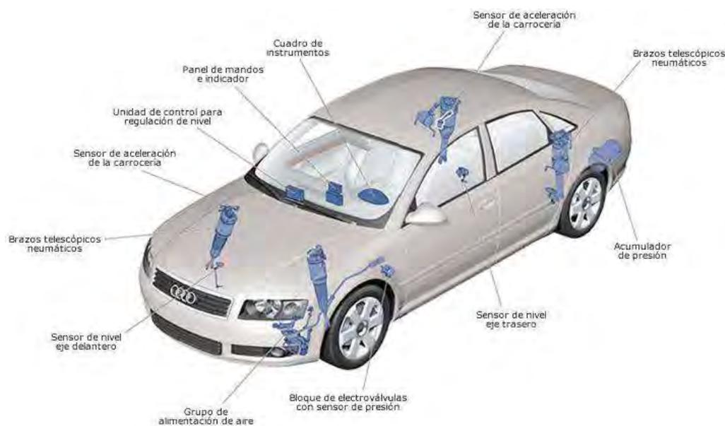
**Figura 35.** Componentes de la suspensión neumática de un Audi A8.
