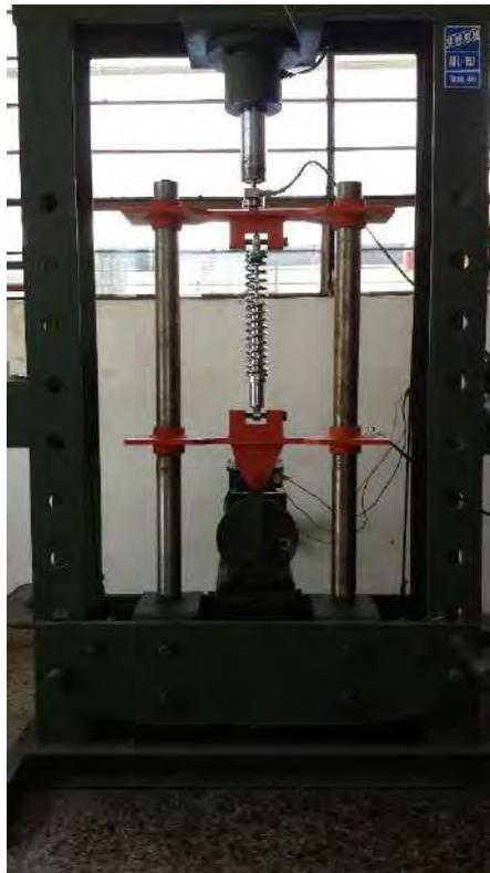
**Figura 111.** Amortiguador montado en el banco de ensayos.
