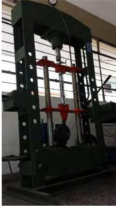
**Figura 83.** Banco de ensayo de amortiguadores en funcionamiento.
