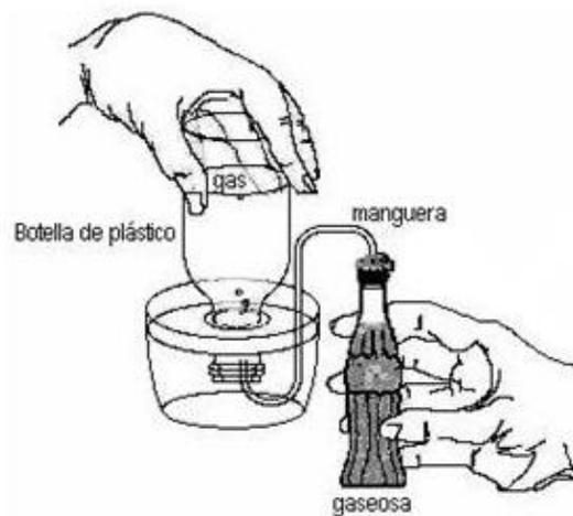
**Figura 31.** Sistema de desplazamiento de agua.
