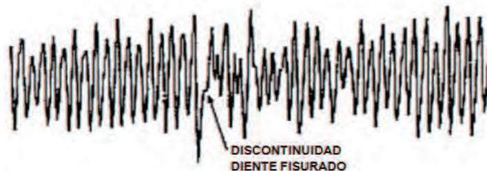
**Figura 3.19.** STA en una forma de onda, 42 horas de vuelos antes del accidente del helicóptero<sup>33</sup>.
