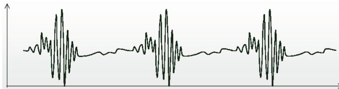
**Figura 3.6.** Ejemplo de vibración por golpeteos intermitentes.
