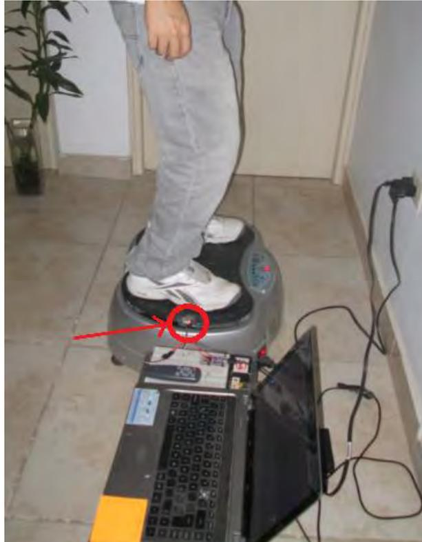
**Figura 4.58.** Modelo parado en plataforma vibratoria. Acelerómetro ubicado fijamente en extremo izquierdo (flecha).
