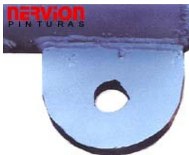
**Figura 2.7. Superficie metálica limpiada con chorro de abrasivo acabado metal blanco<sup>25</sup>.**
