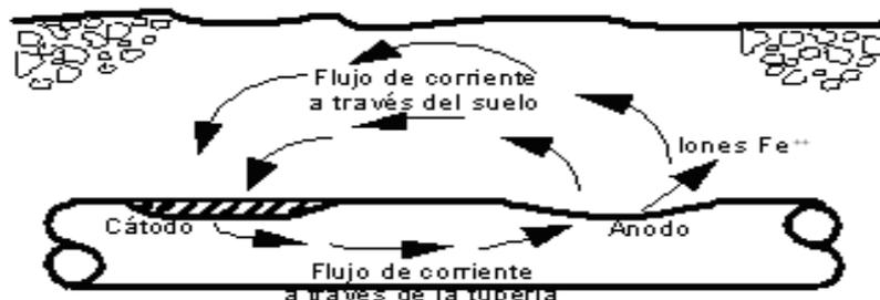
Figura 1.4. Tubería enterrada, la zona con tendencia anódica cede electrones y la zona de tendencia catódica los recibe.
