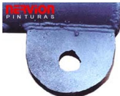
**Figura 2.6. Superficie metálica limpiada con chorro de abrasivo acabado grado comercial<sup>24</sup>.**
