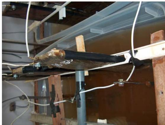
**Figura 5.3.** En esta figura se muestra la probeta G8-36e el día en que terminó el ensayo. Podemos ver como la parte no sumergida también sufrió daños.
