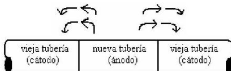
**Figura 1.10. Corrosión debida a superficies disímiles.**
