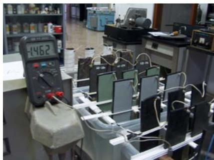
**Figura 4.26 En el extremo izquierdo podemos apreciar el voltímetro de alta resistencia.**
