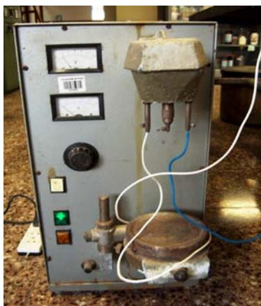
**Figura 4.30. Rectificador de corriente.**
