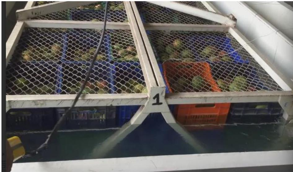
**Figura 2. 9. La canasta se sumerge en el agua contenida por el tanque.**
