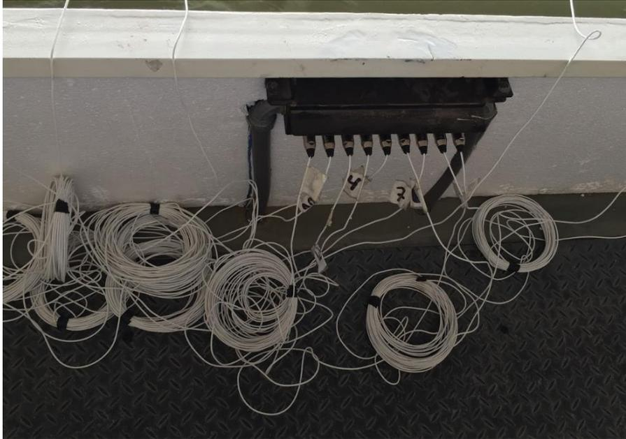
**Figura 3. 15. Cables de transmisión de las RTD's al PLC.**
