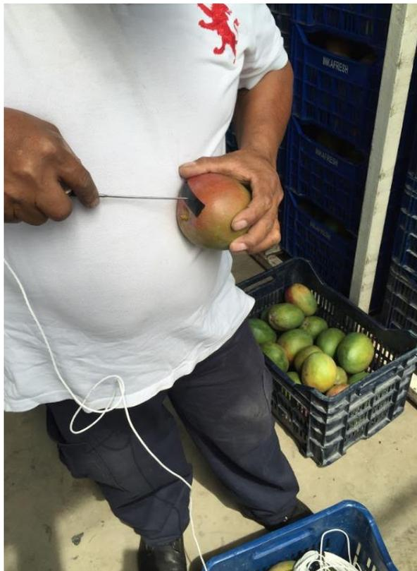
**Figura 3. 14. Colocación de RTD en el interior del mango.**
