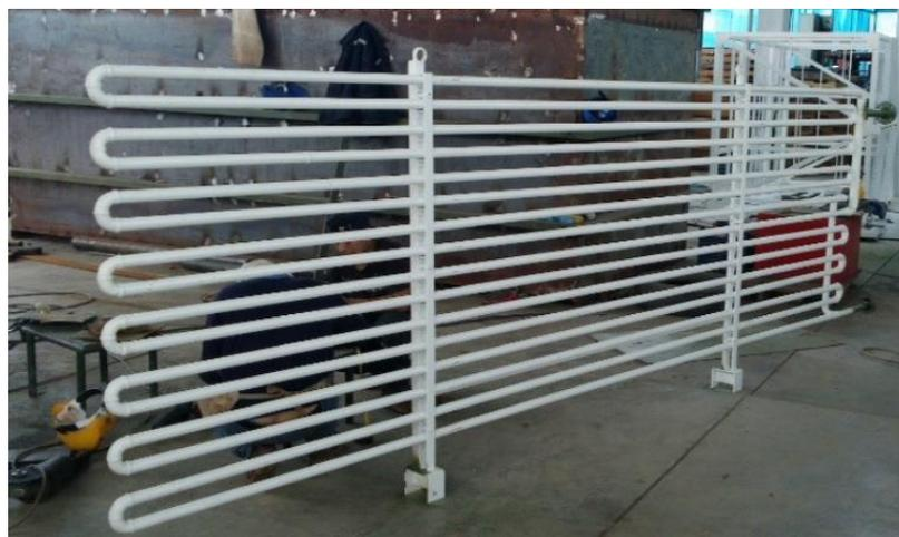
**Figura 2. 3. Serpentines para intercambio de calor.**
