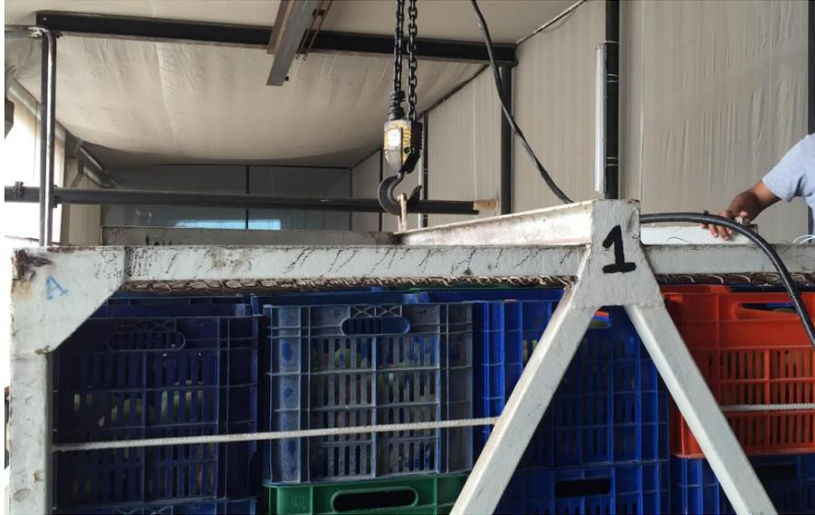
**Figura 2. 8. La canasta se eleva por una grúa y se desplaza hacia el tanque.**
