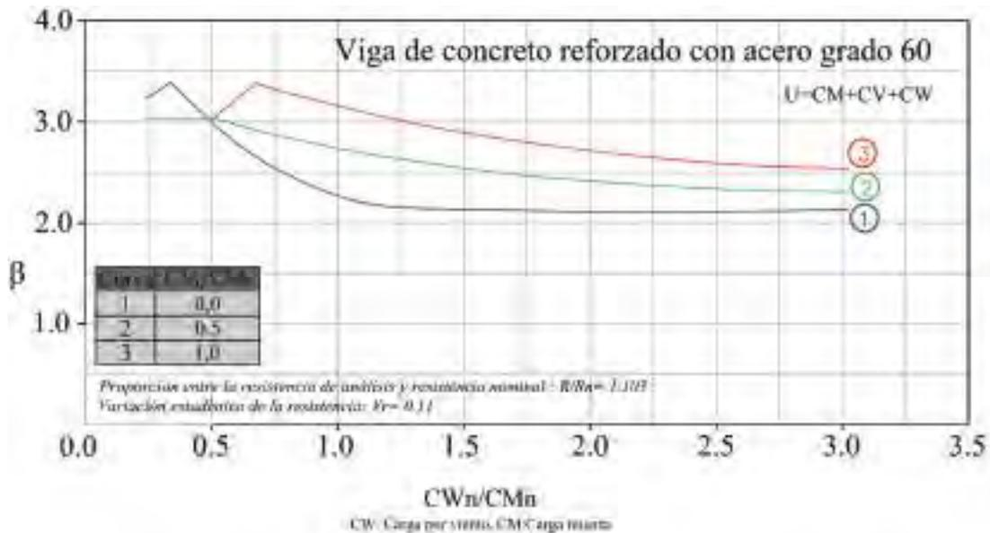
Figura 67: Índice de confiabilidad para vigas de concreto reforzado para carga medioambiental de viento. Fuente: NBS (1980).
