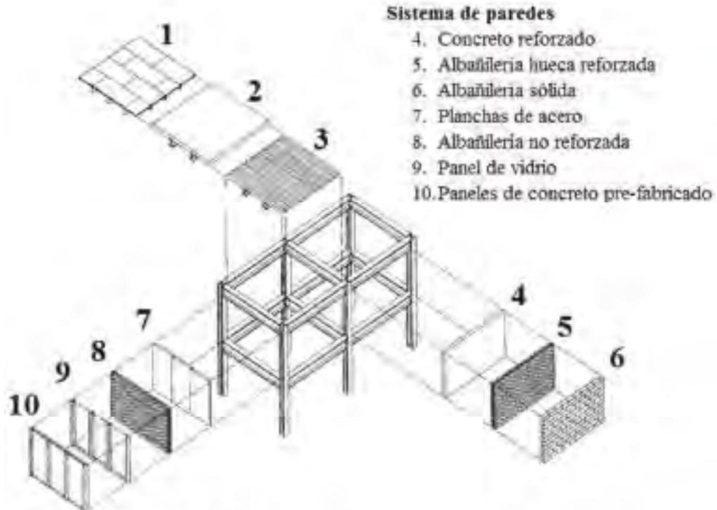
Figura 26: Esquema de estructura de acero con põrtico momento resistente. Fuente: FEMA 154 (2002)
