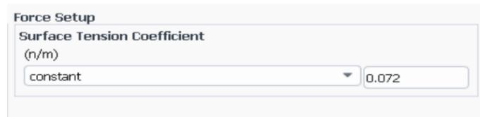
Figura 31 Configuración de parámetro para tensión superficial
