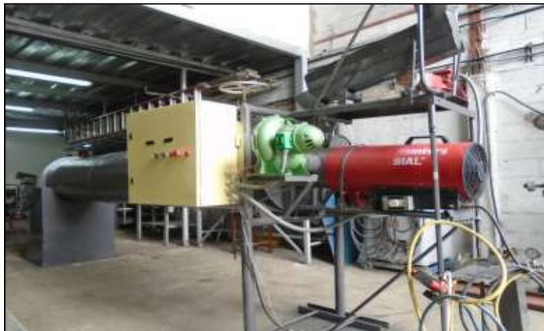
Figura 9. Secador artificial de cacao por convección forzada.
